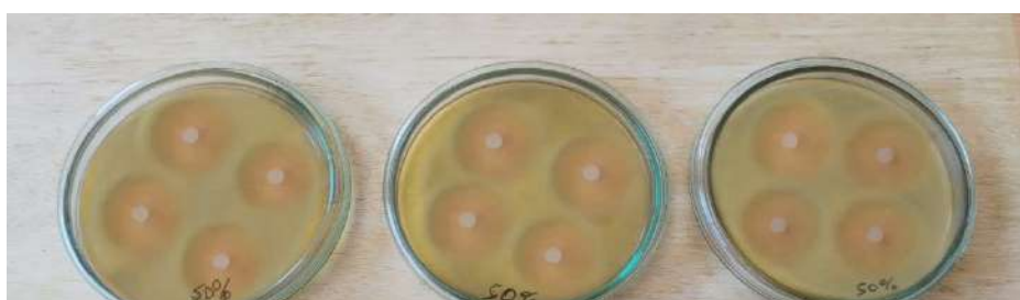
Gráfico 5. Halos de inhibición de tamaño considerable a la concentración de 50% en placas Petri
