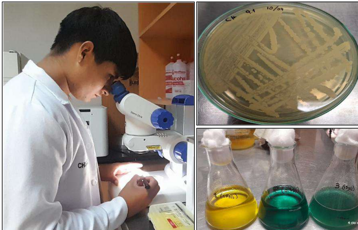
Figura 24. Evaluación de producción de auxinas mediante la técnica colorimétrica con reactivo de Salkowsky
