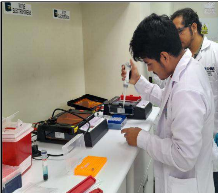
Figura 8. Electroforesis horizontal de ADN extraído de Cepas de Bacillus
