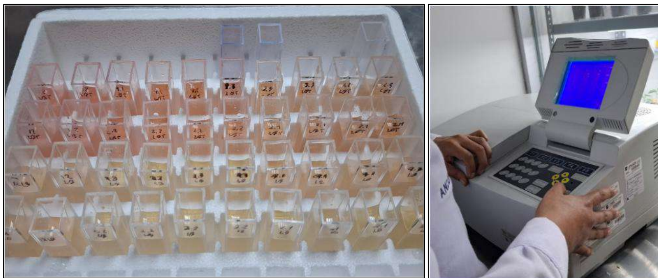
Figura 24. Evaluación de producción de auxinas mediante la técnica colorimétrica con reactivo de Salkowsky
