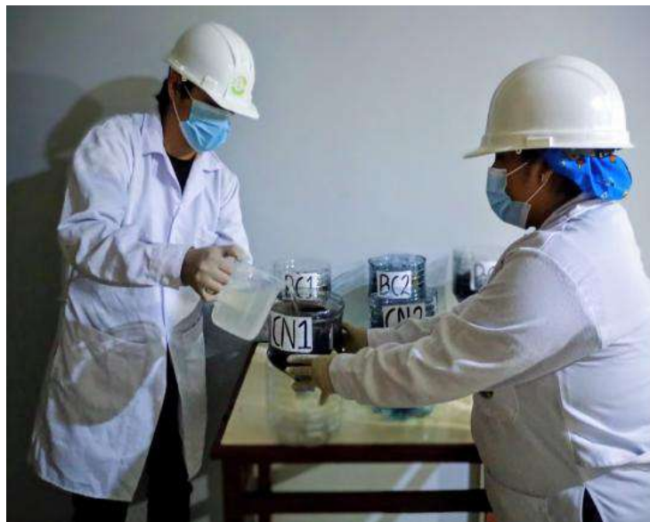
Figura 30. Introducción del efluente de lavado de vehículos dentro de los biochar. Elaboración propia.
