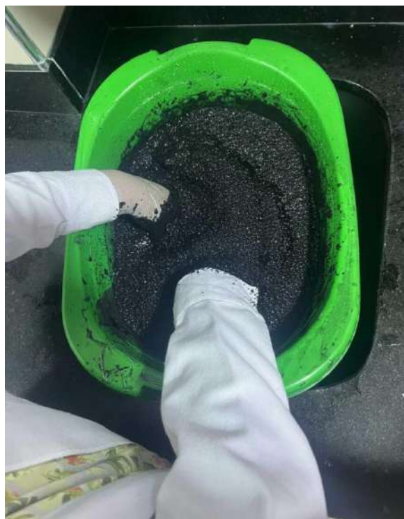
Figura 24. Lavado del biochar de naranja. Elaboración propia.
