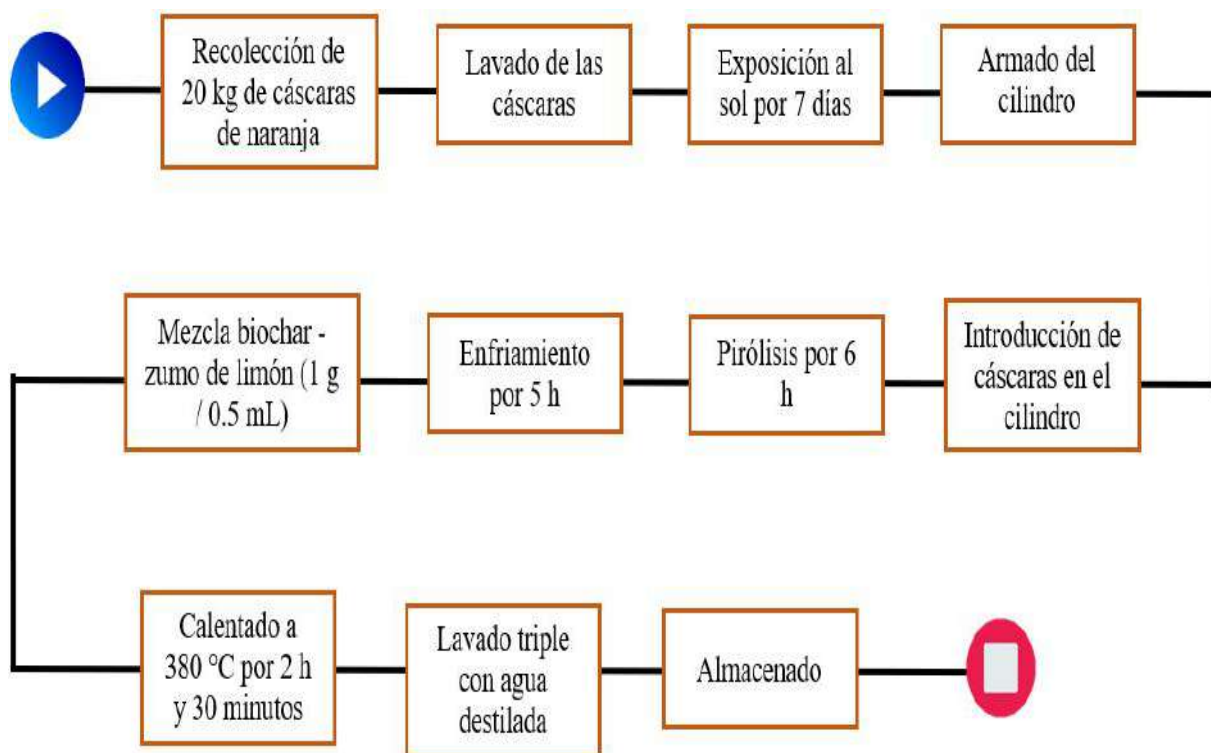
Figura 25. Síntesis de preparación de biochar de cáscara de naranja. Elaboración propia.
