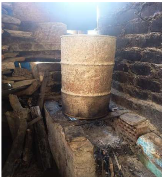
Figura 21. Enfriamiento del biochar de naranja. Elaboración propia.
