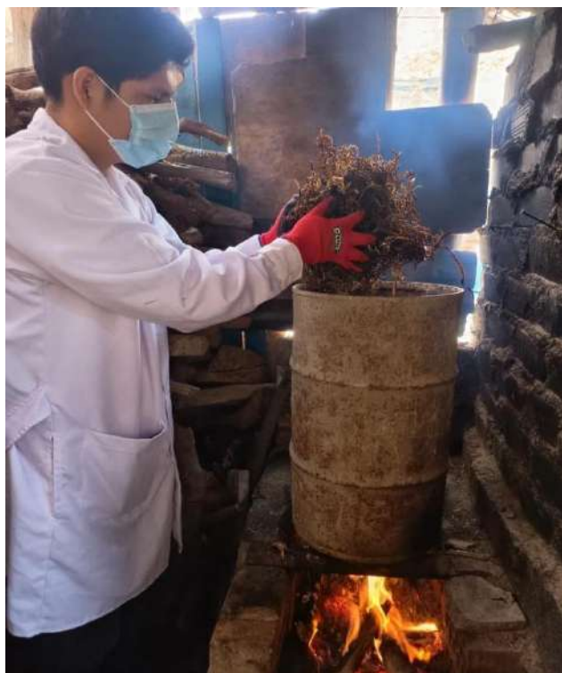
Figura 19. Introducción de cáscaras de naranja en cilindro. Elaboración propia.
