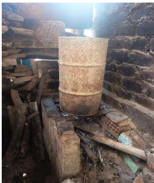
Figura 11. Enfriamiento del biochar de bagazo de caña. Elaboración propia.
