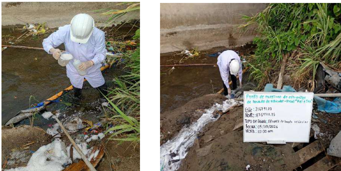
Figura 27. Llenado de los envases con los efluentes del lavado vehicular. Elaboración propia.
