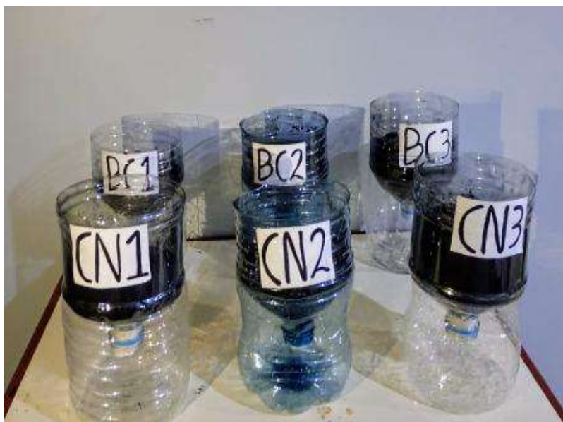
Figura 29. Filtros llenos con biochar de naranja y bagazo de caña según tratamientos. Elaboración propia.
