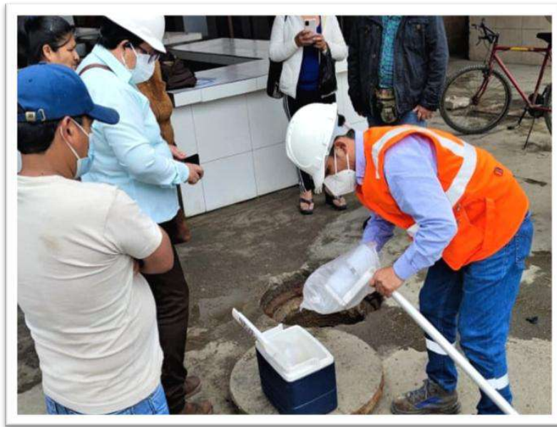
Foto 41. Toma de muestra del sumidero principal por parte de la EPS - Barranca
