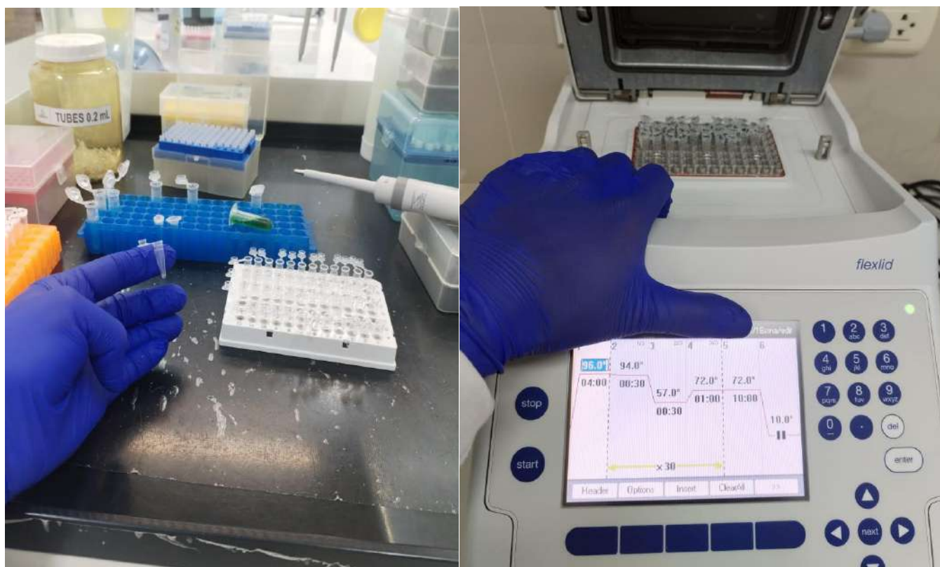
Figura 8: A) Preparación de la máster mix. B) Tiempos de ciclado en el termociclador para la amplificación de las muestras de PCR
