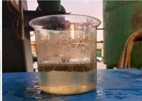
h) Prueba de jarra de lodos y agua clarificada.
