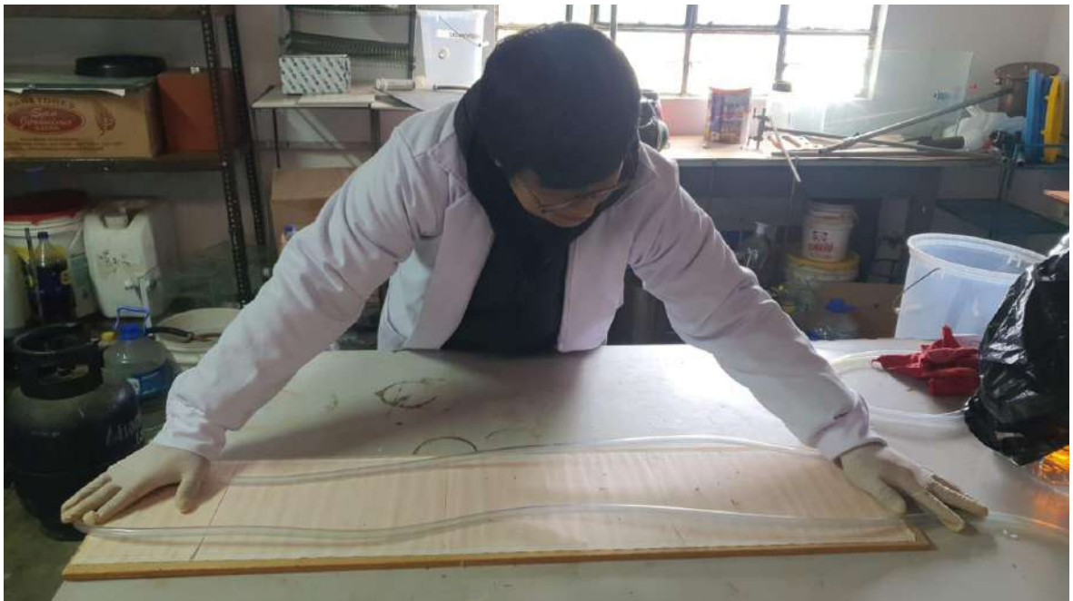
Figura 18. Construcción del manómetro
