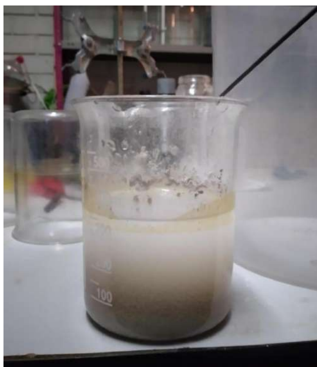
Figura 14. Preparación de una solución agua con cal para el neutralizado de la carga.
