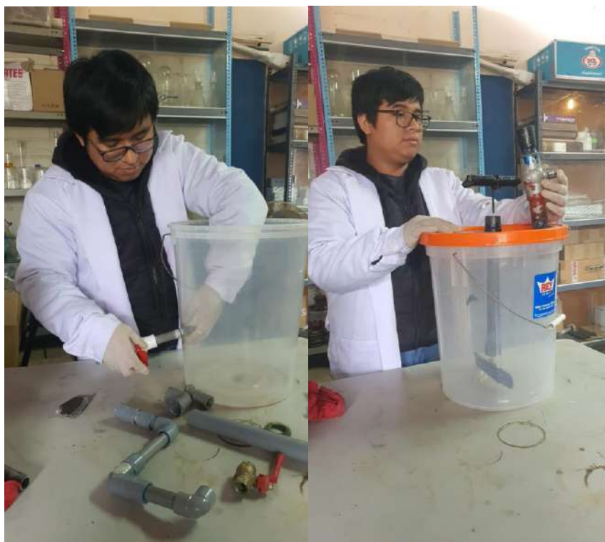
Figura 13. Instalación de los tubos PVC, Termómetro, manguera transparente en la tapa del contenedor.
