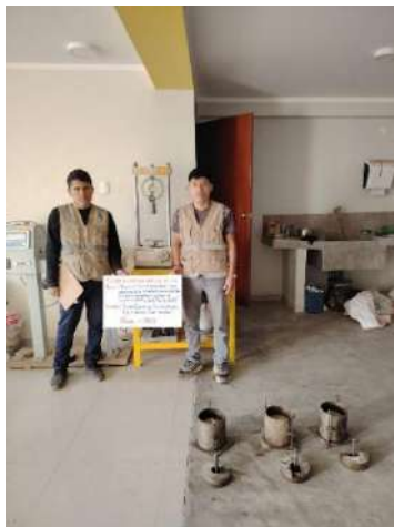
Foto 39: Inicio de ensayo de CBR de los moldes.
