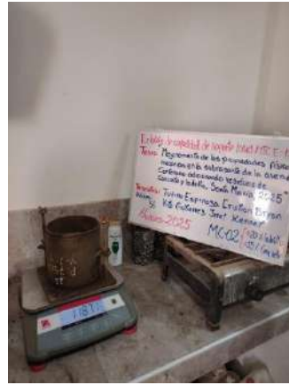
Foto 62: Pesaje del molde de la dosificación 03 (20%RL+15%RC) para el ensayo de CBR.
