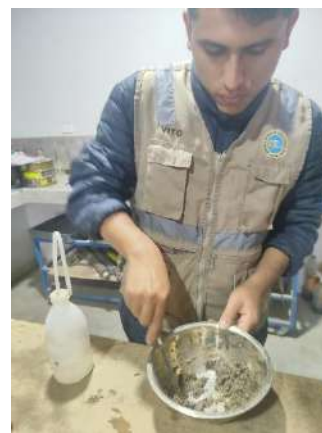
Foto 24: Combinación de la muestra natural con agua para el ensayo de LL.
