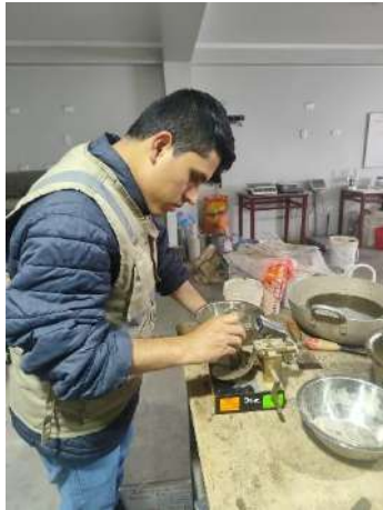
Foto 25: Colocando la muestra a la copa de Casagrande.
