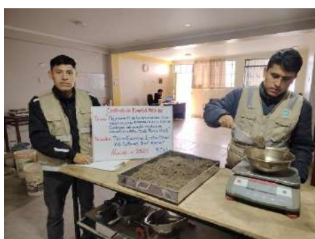
Foto 15: Pesaje de la muestra de la CLT-1 para hallar el CH.
