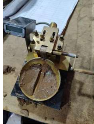
Foto 50: Ensayo LL de la dosificación 03 (20%RL+15%RC).
