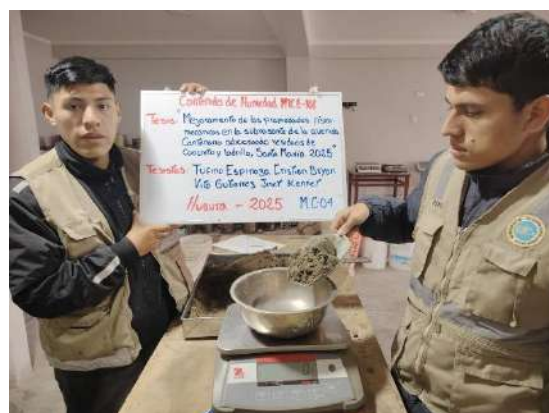
Foto 18: Pesaje de la muestra de la CLT-4 para hallar el CH.
