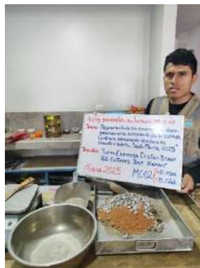
Foto 45: Preparación de la dosificación 02 (15%RL+20%RC).
