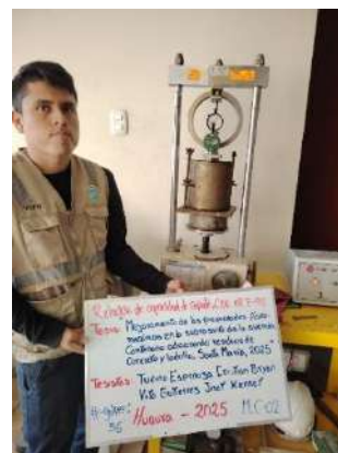
Foto 42: Ensayo de CBR de la CLT-2 compactada con 56 golpes.
