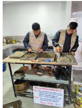
Foto 28: Cuarteo para la preparación del molde para el ensayo de Proctor.
