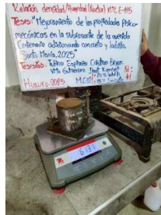
Foto 52: Pesaje del molde de la dosificación 02 (15%RL+20%RC) para el ensayo de Proctor.
