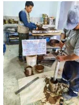
Foto 58: Compactación de dosificación 02 (15%RL+20%RC) para el ensayo de CBR.
