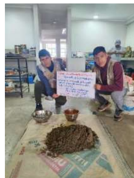
Foto 54: Preparación de la dosificación 03 (20%RL+15%RC) para el ensayo de Proctor.
