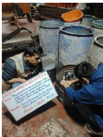
Foto 35: Colocación de dial en los moldes para su posterior sometimiento a la prensa.
