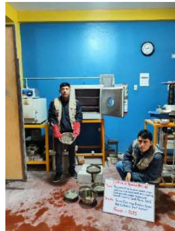
Foto 22: Retiro del horno de todas las muestras después del secado.
