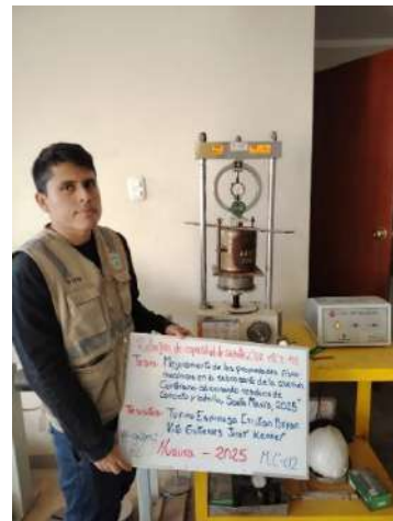
Foto 40: Ensayo de CBR de la CLT-2 compactada con 12 golpes.
