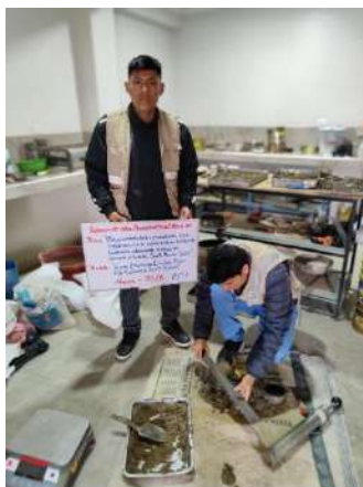
Foto 29: Preparación de la muestra natural para el ensayo de Proctor.
