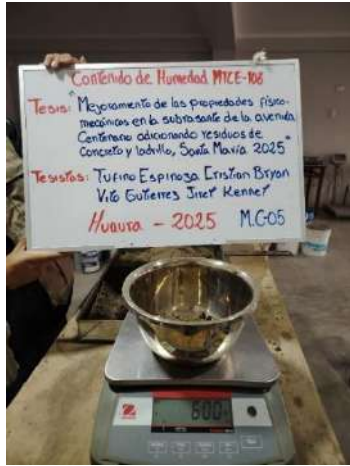
Foto 19: Pesaje de la muestra de la CLT-5 para hallar el CH.
