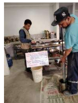
Foto 60: Compactación de dosificación 03 (20%RL+15%RC) para el ensayo de CBR.
