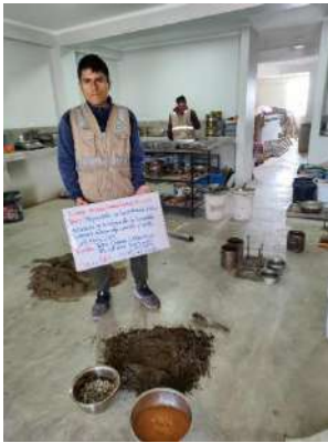
Foto 51: Preparación de la dosificación 02 (15%RL+20%RC) para el ensayo de Proctor.
