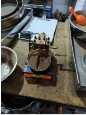
Foto 49: Ensayo LL de la dosificación 02 (15%RL+20%RC).
