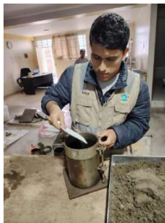
Foto 32: Preparación del molde para el ensayo de CBR.
