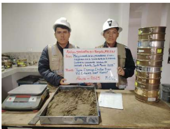
Foto 13: Análisis granulométrico de muestra natural de CLT-1.
