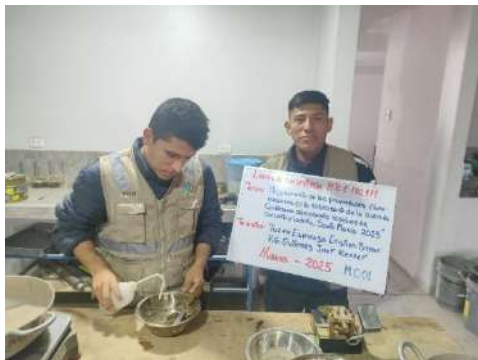
Foto 23: Preparación de material para el ensayo de LL, adición de agua a la muestra.
