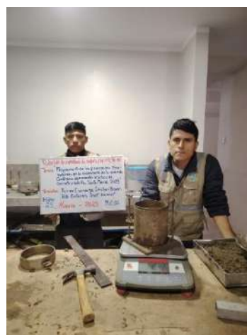
Foto 34: Pesaje de la muestra natural con el molde para el ensayo de CBR.
