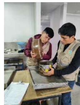
Foto 48: Análisis granulométrico de las dosificaciones 02 (15%RL+20%RC) y 03 (20%RL+15%RC).
