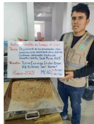
Foto 46: Preparación de la dosificación 03 (20%RL+15%RC).
