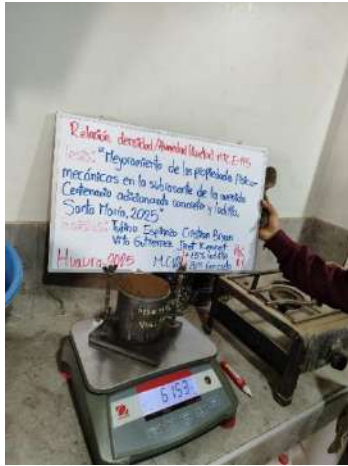
Foto 55: Pesaje del molde de la dosificación 03 (20%RL+15%RC) para el ensayo de Proctor.
