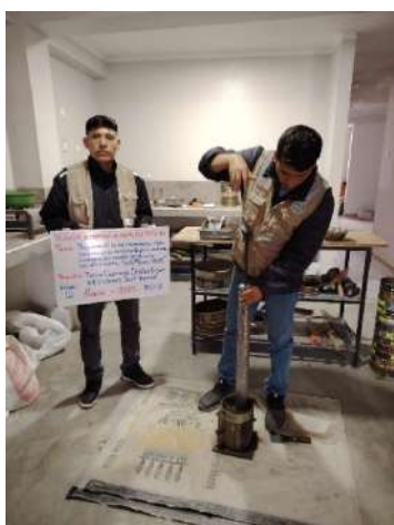
Foto 33: Compactación de muestra natural para el ensayo de CBR.
