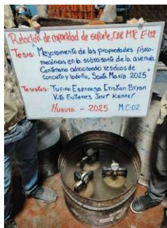
Foto 36: Reposo de los moldes para su posterior sometimiento a la prensa.
