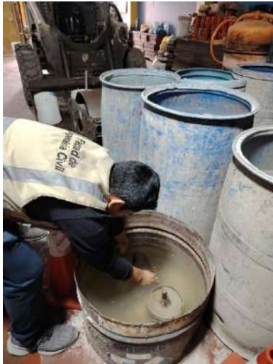
Foto 37: Retiro de los moldes sumergidos en agua luego del tiempo cumplido.
