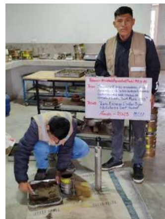
Foto 30: Preparación de la muestra natural para el ensayo de Proctor.
