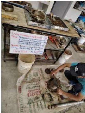
Foto 61: Compactación de dosificación 03 (20%RL+15%RC) para el ensayo de CBR.
