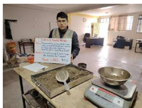
Foto 16: Pesaje de la muestra de la CLT-2 para hallar el CH.
