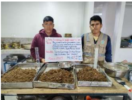
Foto 57: Preparación de la dosificación 02 (15%RL+20%RC) para el ensayo de CBR.
