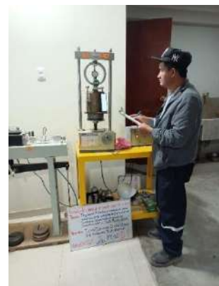
Foto 66: Ensayo de CBR de la dosificación 03 (20%RL+15%RC).
