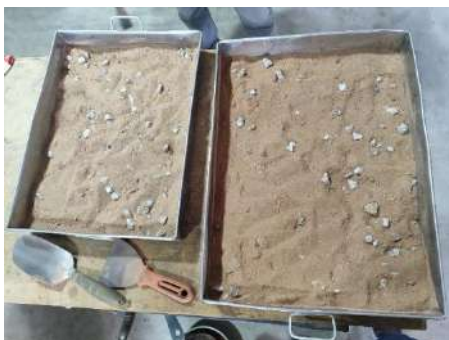
Foto 47: Preparación de las dosificaciones 02 (15%RL+20%RC) y 03 (20%RL+15%RC).
