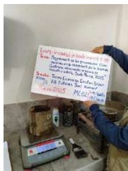
Foto 59: Pesaje del molde de la dosificación 02 (15%RL+20%RC) para el ensayo de CBR.
