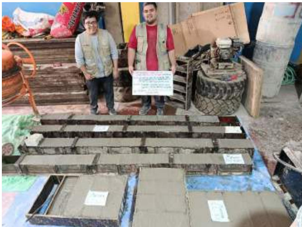
Fotografía N°30: Preparación y curado especímenes cilíndricos y vigas concreto (NTP 339.033)
