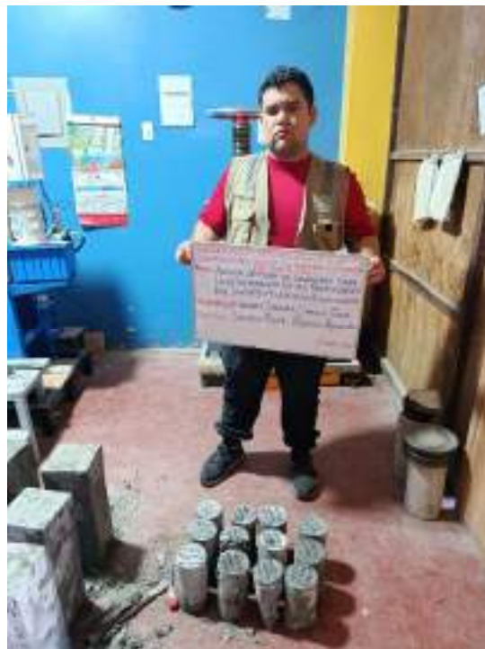
Fotografía N°33: Determinación resistencia compresión concreto – 7 días calendario (ensayo normalizado NTP 339.034)
