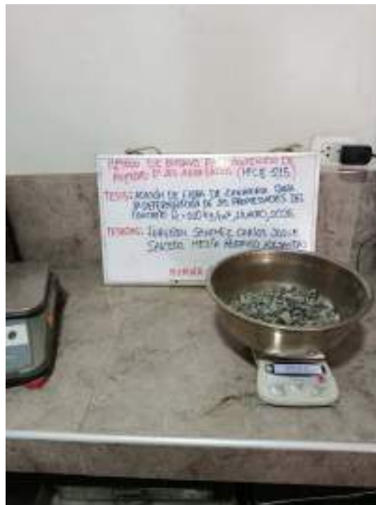
Fotografía N°18: Prueba granulometría agregados grueso y fino (NTP 400.012 / MTC E-204)
