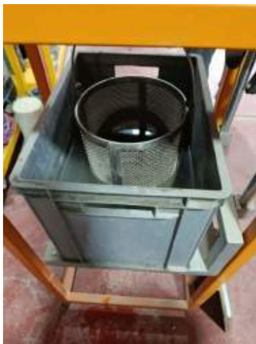
Fotografía N°11: Determinación gravedad específica y absorción agregados (MTC E-205, 206)
