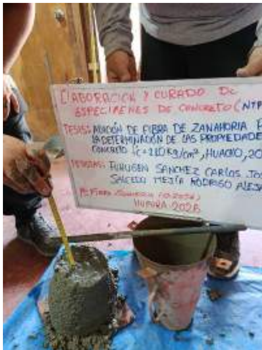
Fotografía N°26: Prueba consistencia SLUMP mediante cono de Abrams (NTP 339.035)
