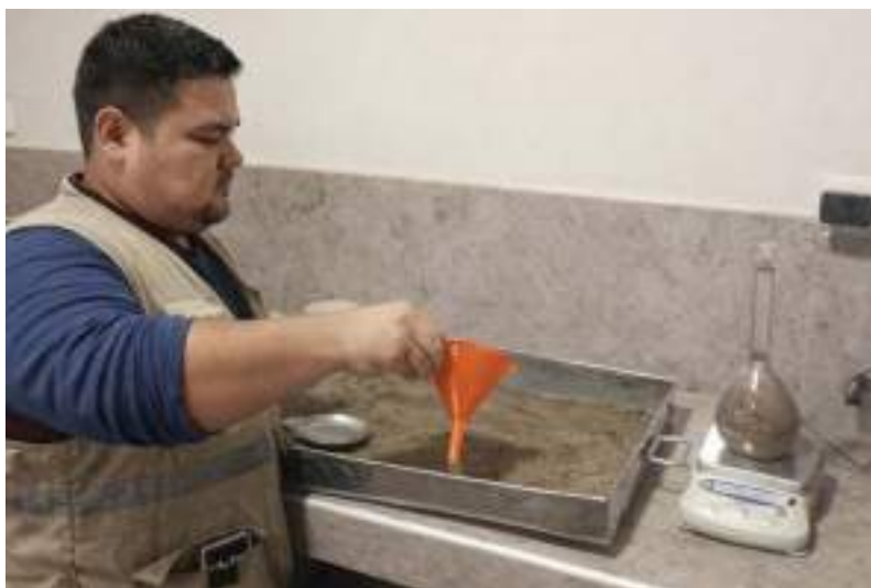
Fotografía N°13: Determinación gravedad específica y absorción agregados (MTC E-205, 206)
