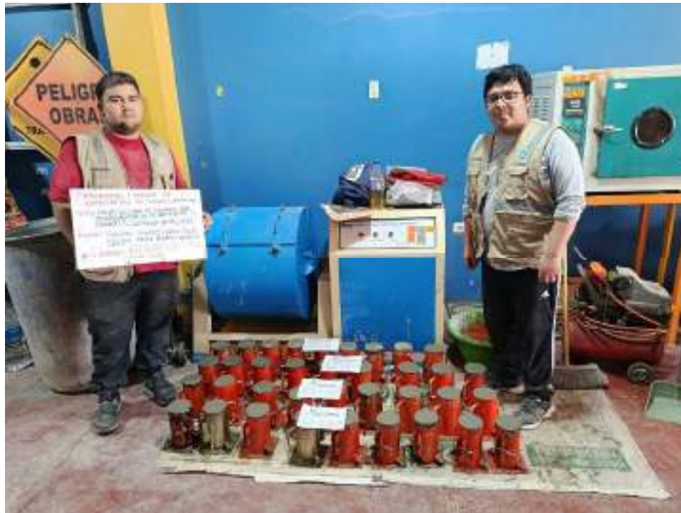
Fotografía N°29: Preparación y curado especímenes cilíndricos y vigas concreto (NTP 339.033)
