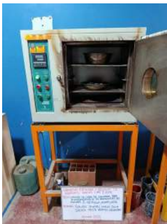
Fotografía N°12: Determinación gravedad específica y absorción agregados (MTC E-205, 206)
