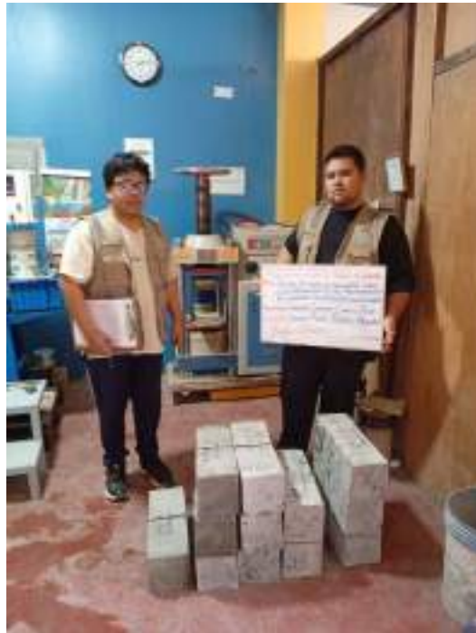
Fotografía N°37: Determinación resistencia a la flexión del concreto – 14 días calendario (ensayo normalizado NTP 339.078)
