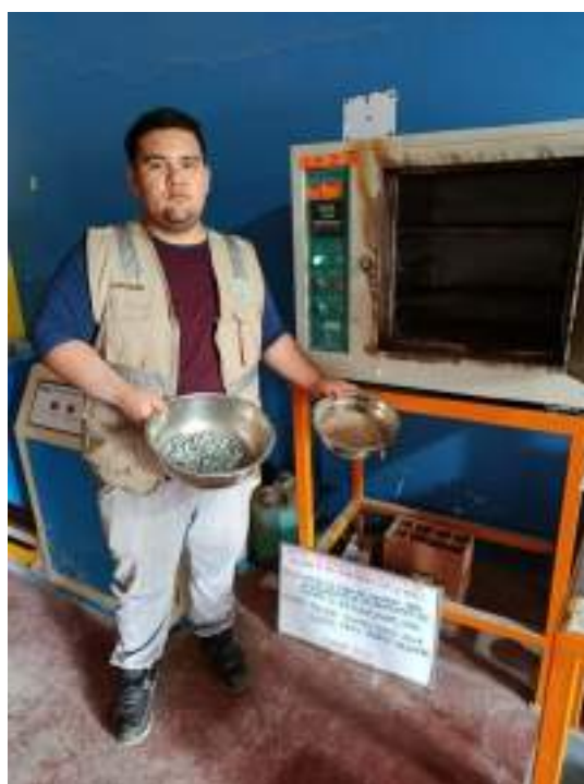
Fotografía N°08: Ensayo contenido de humedad agregados (MTC E-108)
