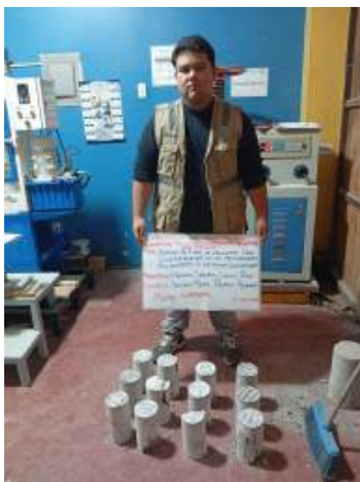
Fotografía N°35: Determinación resistencia a la compresión del concreto – 28 días calendario (ensayo normalizado NTP 339.034)
