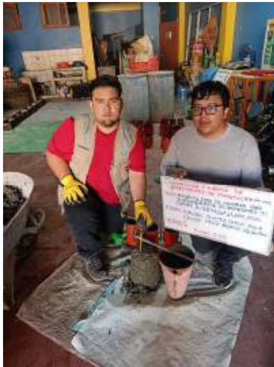
Fotografía N°25: Prueba consistencia SLUMP mediante cono de Abrams (NTP 339.035)
