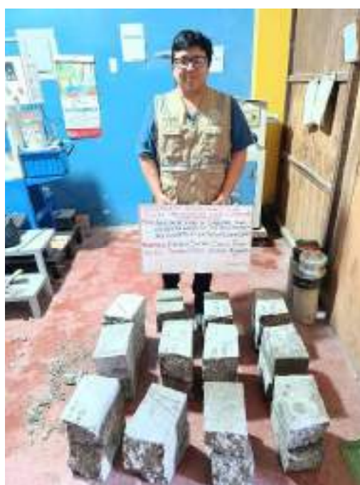
Fotografía N°36: Determinación resistencia a la flexión del concreto – 7 días calendario (ensayo normalizado NTP 339.078)
