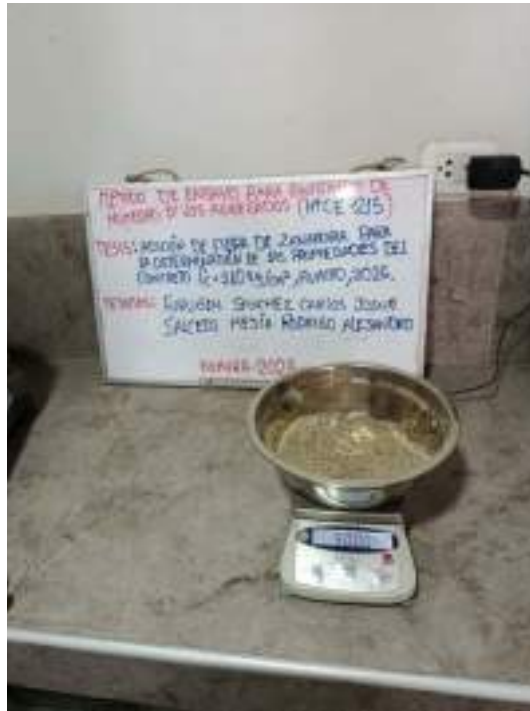
Fotografía N°19: Prueba granulometría agregados grueso y fino (NTP 400.012 / MTC E-204)
