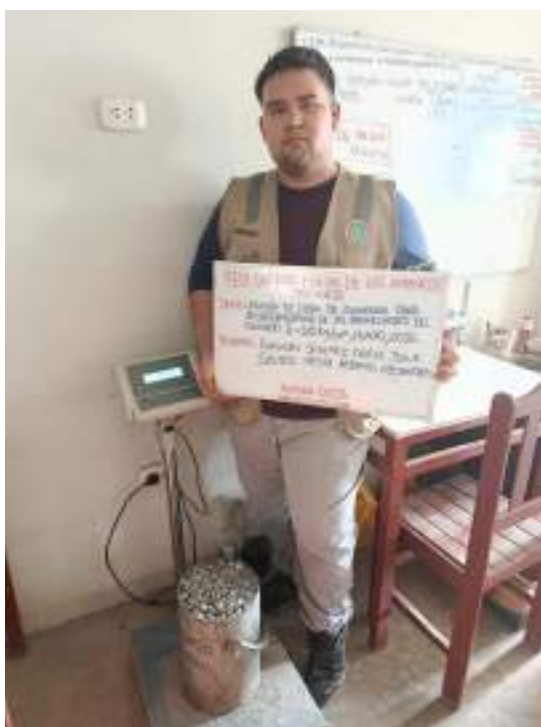
Fotografía N°07: Ensayo peso unitario y vacíos de agregados (MTC E-203)
