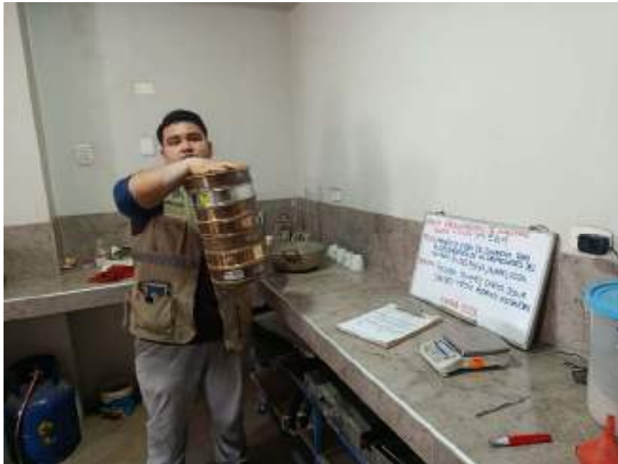
Fotografía N°15: Prueba granulometría agregados grueso y fino (NTP 400.012 / MTC E-204)
