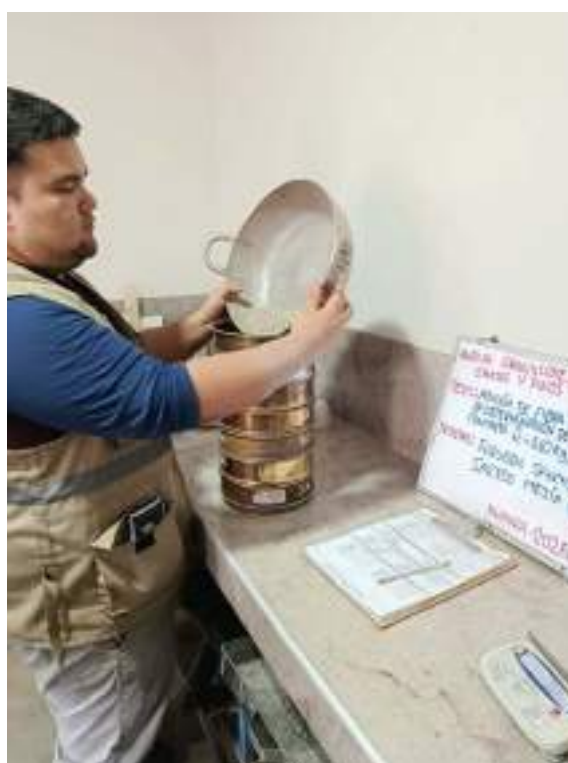
Fotografía N°14: Prueba granulometría agregados grueso y fino (NTP 400.012 / MTC E-204)
