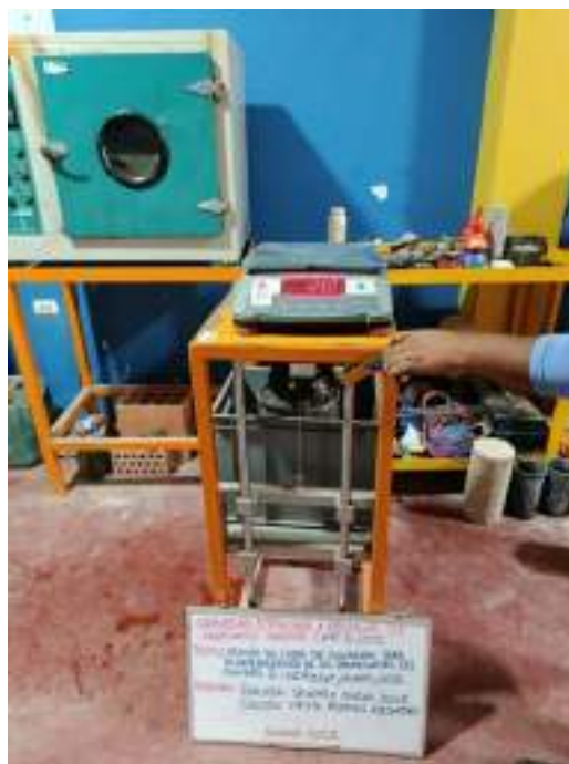
Fotografía N°10: Determinación gravedad específica y absorción agregados (MTC E-205, 206)
