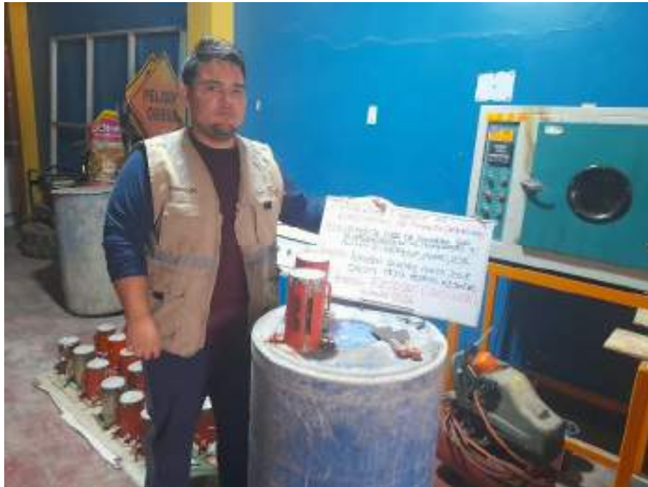
Fotografía N°31: Preparación y curado especímenes cilíndricos y vigas concreto (NTP 339.033)
