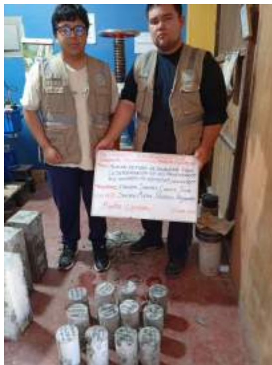
Fotografía N°34: Determinación resistencia compresión concreto – 14 días calendario (ensayo normalizado NTP 339.034)
