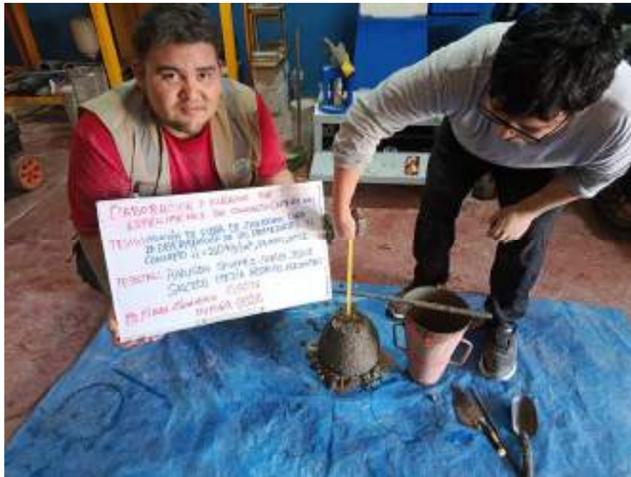
Fotografía N°27: Prueba consistencia SLUMP mediante cono de Abrams (NTP 339.035)
