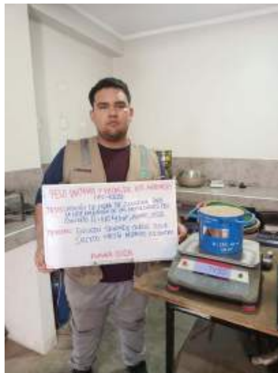
Fotografía N°06: Ensayo peso unitario y vacíos de agregados (MTC E-203)
