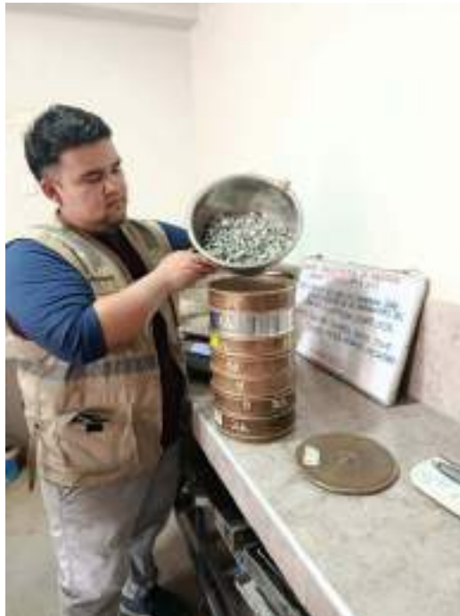
Fotografía N°17: Prueba granulometría agregados grueso y fino (NTP 400.012 / MTC E-204)
