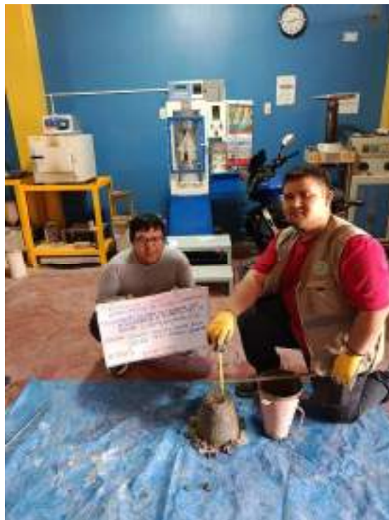
Fotografía N°28: Prueba consistencia SLUMP mediante cono de Abrams (NTP 339.035)
