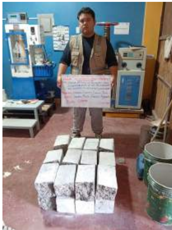
Fotografía N°38: Determinación resistencia a la flexión del concreto – 28 días calendario (ensayo normalizado NTP 339.078)
