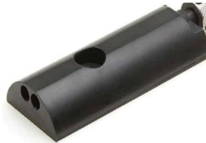
Figura 36. Sensor de turbidez y conductividad en el multiparámetro Fuente: Propia.
