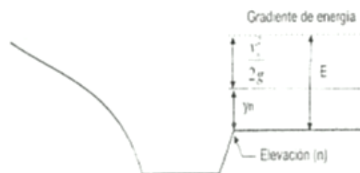
Figura 3.6 Esquema de cálculo de la elevación del gradiente de energía después del resalto
