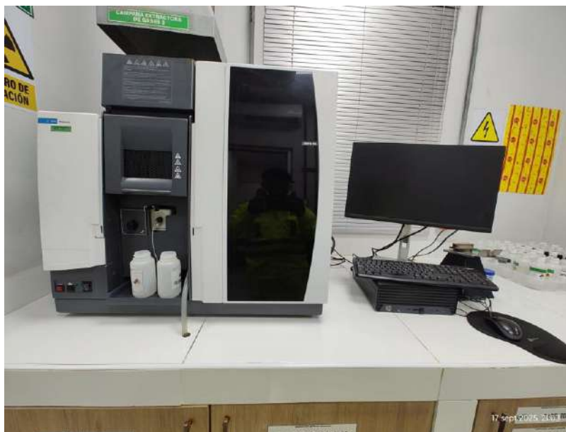
Figura 21 Equipo de absorción atómica Agilent 280FS AA
