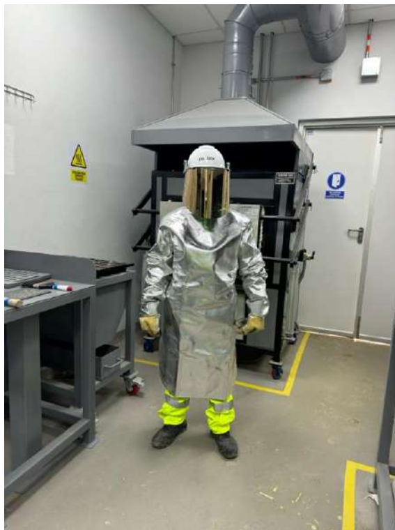
Figura 12 Implementos de seguridad fundición de muestra.
