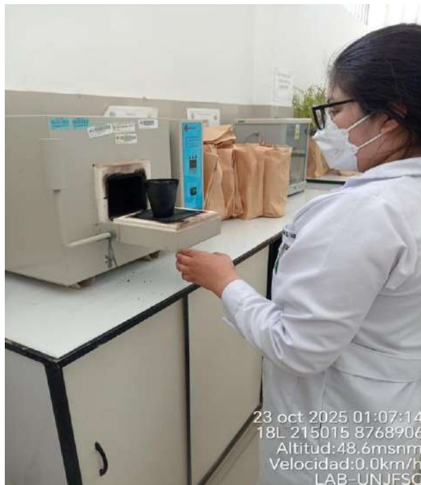
Figura 3. Tostado de semillas en mufla
