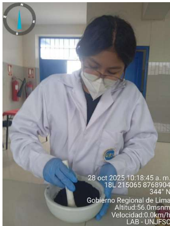
Figura 10. Molienda final de carbón activado de semilla de girasol
