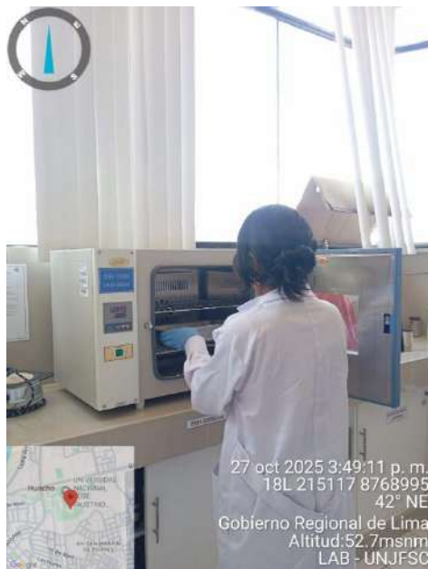
Figura 9. Secado final de carbón activado física y químicamente en estufa
