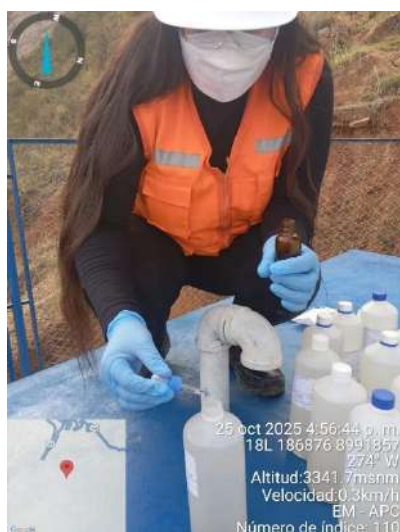
Figura 26. Preservación con ácido nítrico
