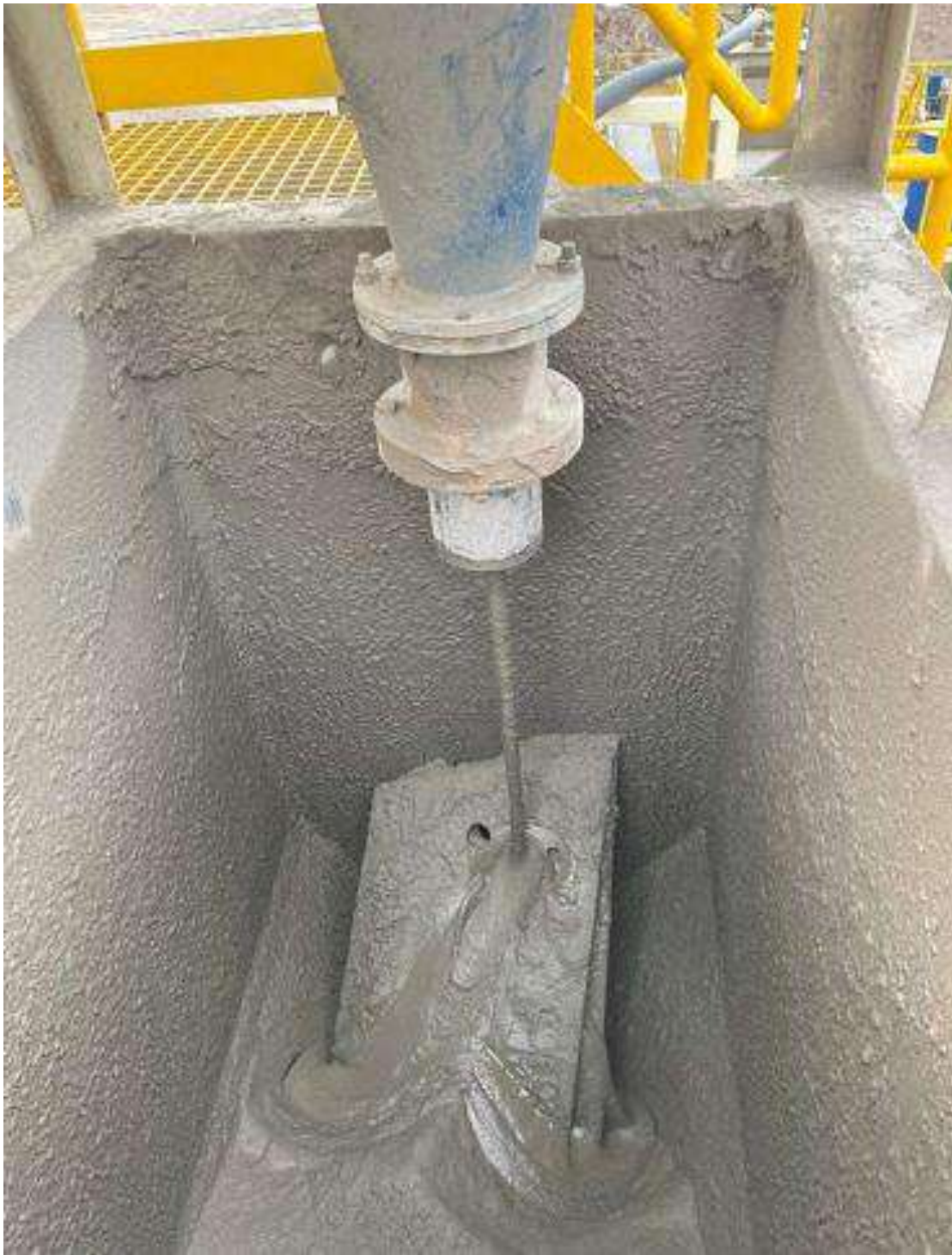
Figura 8. Descarga de Underflow en forma de soga-primer muestreo
