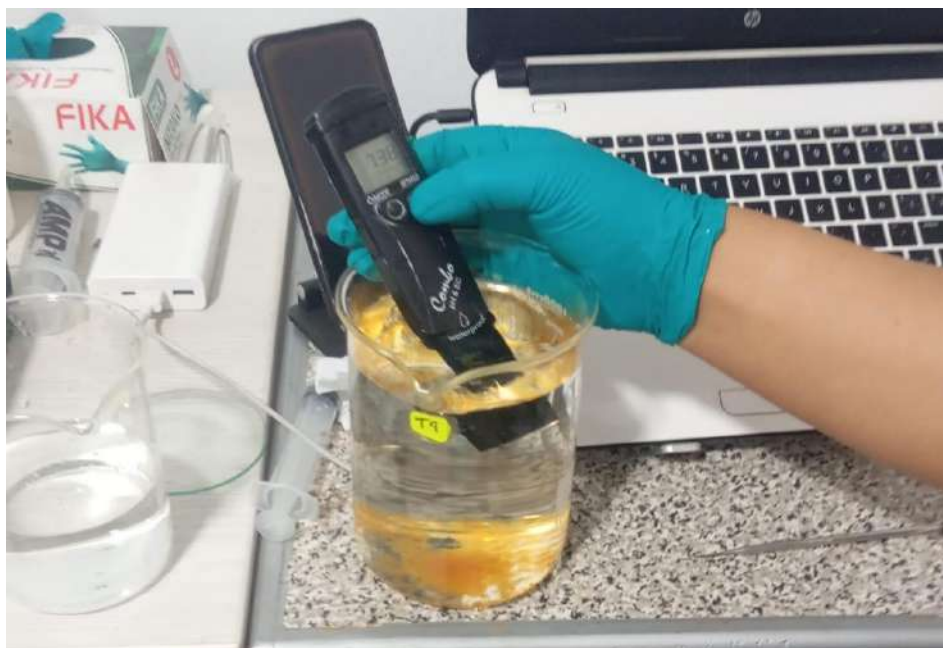
Figura 87: Resultado del pH obtenido en laboratorio al aplicar cloruro férrico
