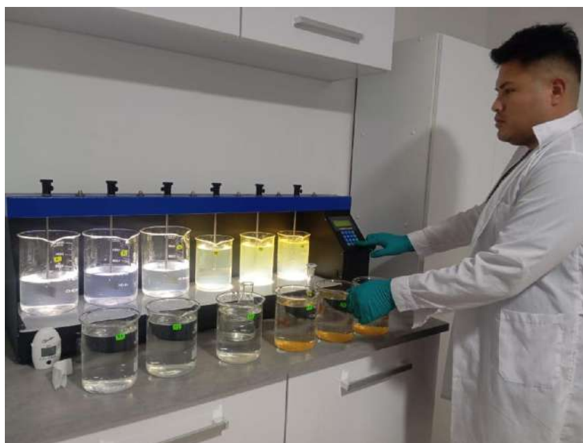
Figura 84: Aplicación de la prueba de jarras (Jar Test) en laboratorio
