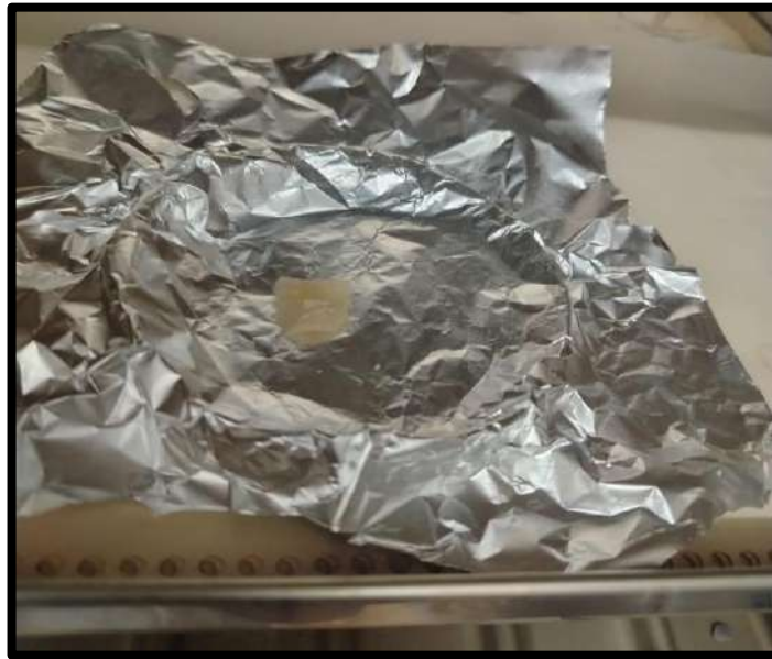
Figura 6. Proceso de secado de cuadrado de bioplástico en la estufa
