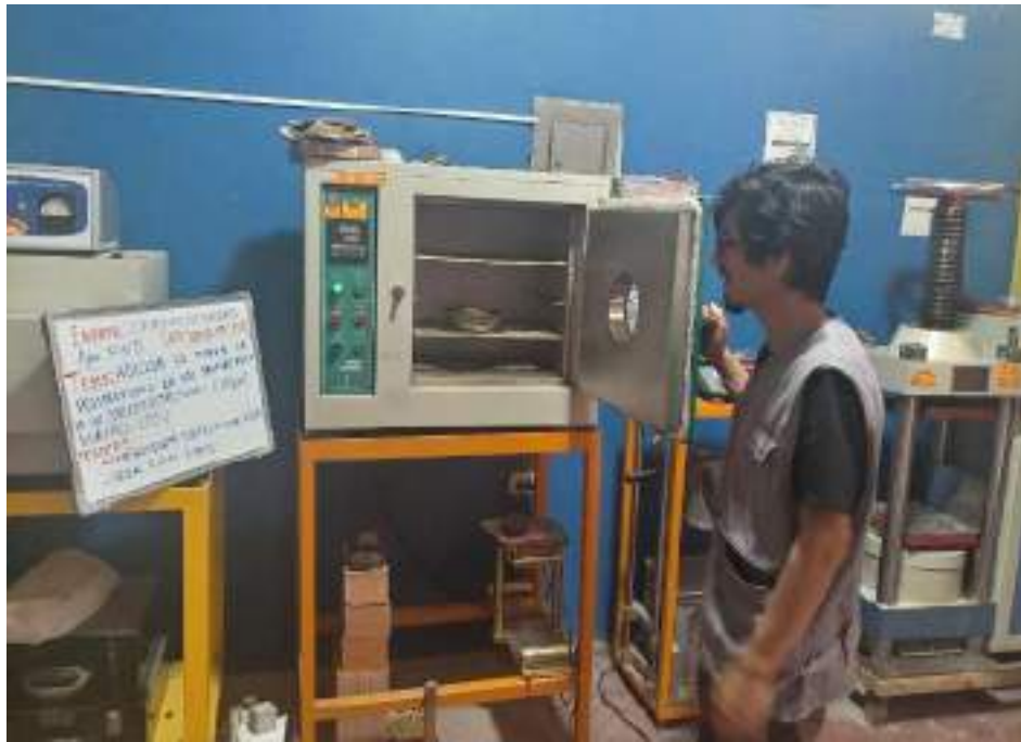
Figura 23. Ensayo Contenido de Humedad del agregado fino.
