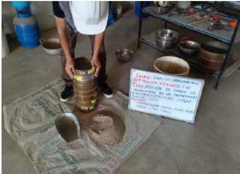
Figura 21. Ensayo granulométrico del agregado fino.
