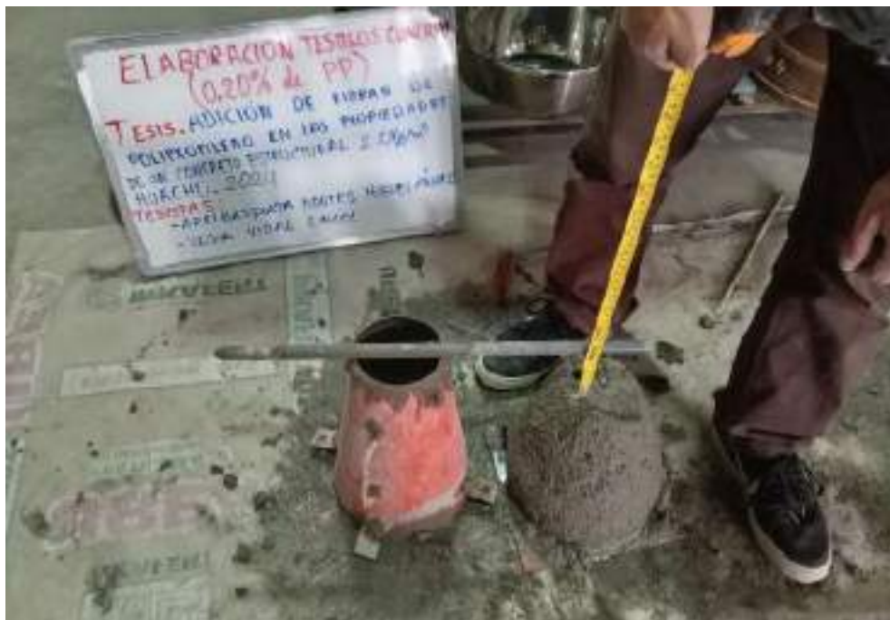
Figura 36. Verificación del Slump del concreto en la muestra de 0.20% de adición fibras de polipropileno.
