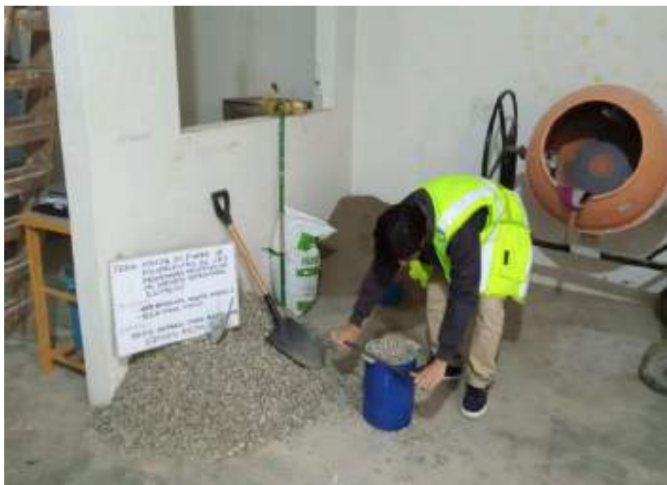
Figura 24. Ensayo Peso Unitario del Agregado Grueso.
