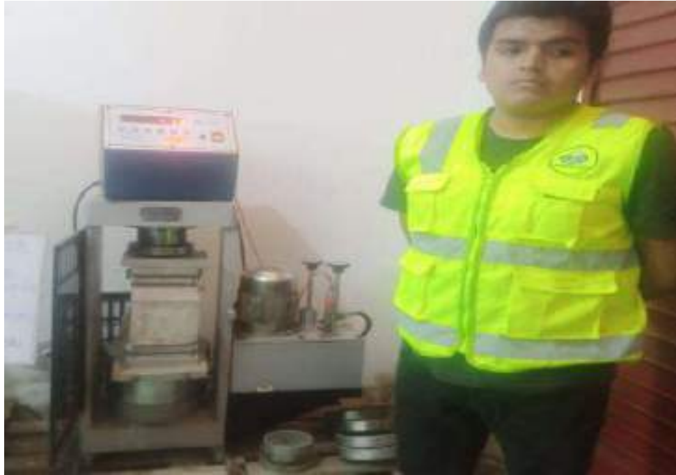
Figura 47. Ensayo de Resistencia a Flexión de las muestras con adición de fibras de polipropileno de 0.50%.
