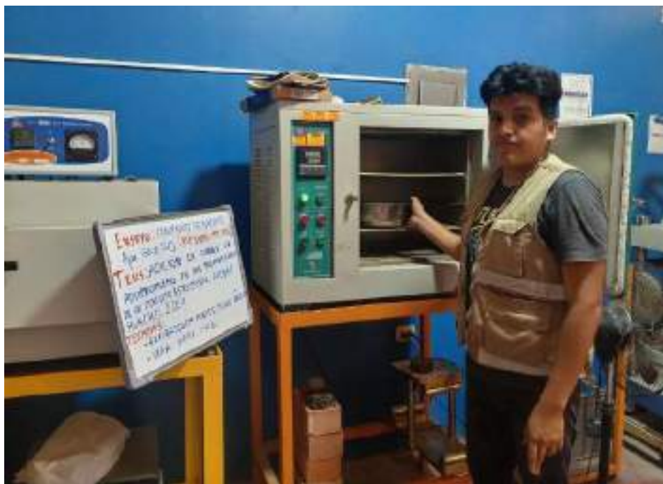
Figura 22. Ensayo Contenido de Humedad del agregado grueso.
