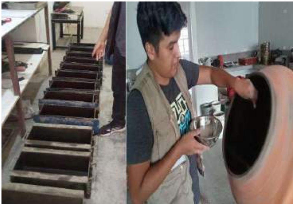
Figura 40. Adición de fibras de polipropileno en las muestras de concreto para las vigas.
