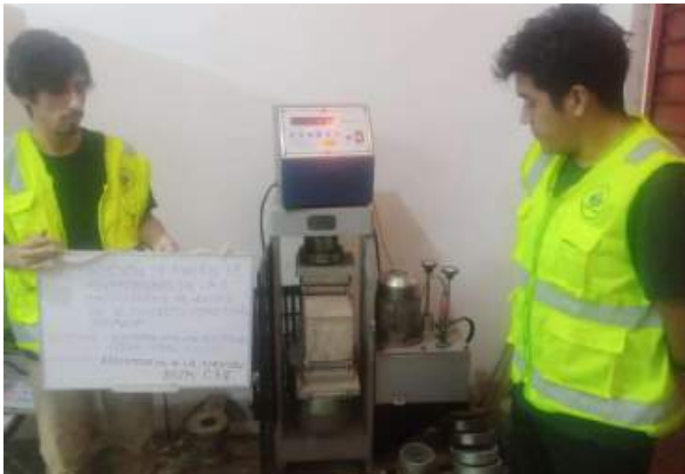
Figura 44. Ensayo de Resistencia a Flexión de la muestra patrón.
