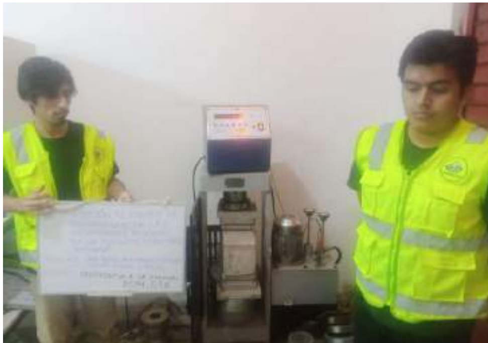
Figura 46. Ensayo de Resistencia a Flexión de las muestras con adición de fibras de polipropileno de 0.20%.
