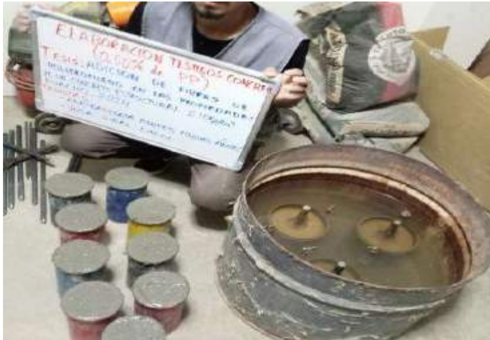
Figura 33. Elaboración de especímenes de concreto de la Muestra de 0.50% de adición fibras de polipropileno.
