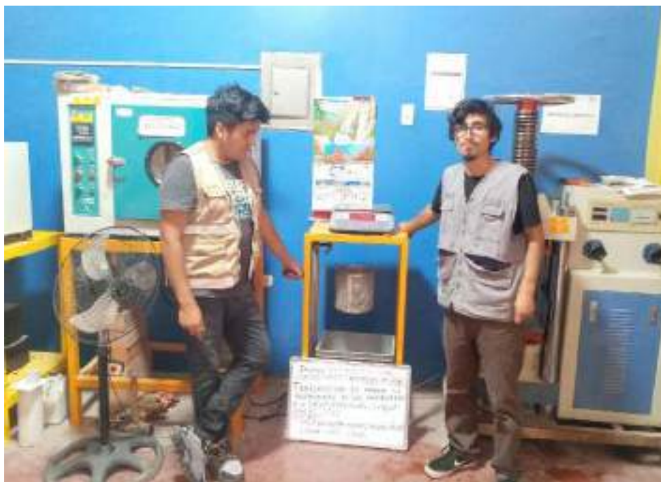
Figura 26. Ensayo de peso específico y absorción del agregado grueso.
