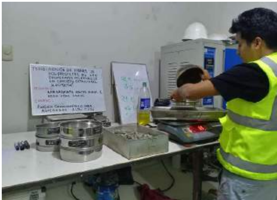
Figura 20. Ensayo granulométrico del agregado grueso.
