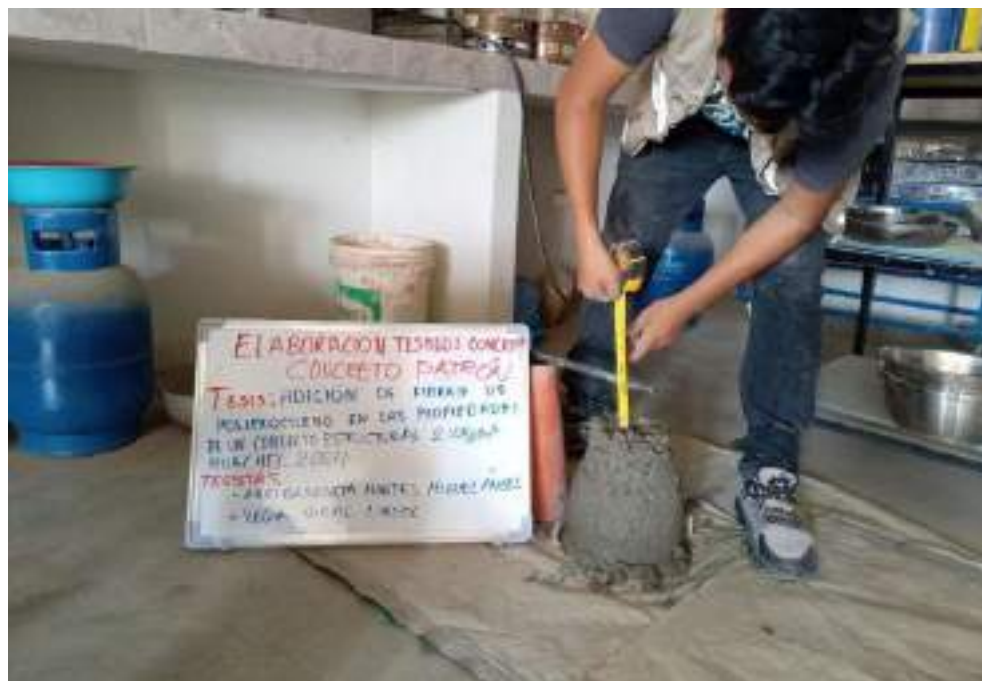
Figura 34. Verificación del Slump del concreto en la muestra patrón.
