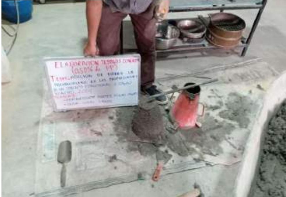
Figura 37. Verificación del slump del concreto en la muestra de 0.50% de adición fibras de polipropileno.
