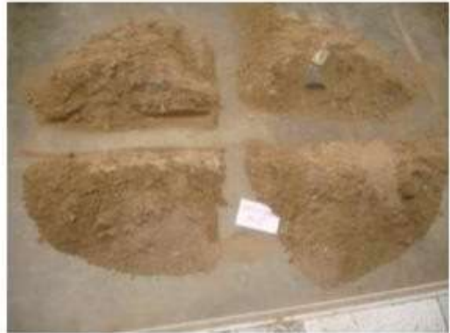
CUARTEO PARA PODER REALIZAR EN ANALISIS GRANULOMETRICO DEL MATERIAL.
