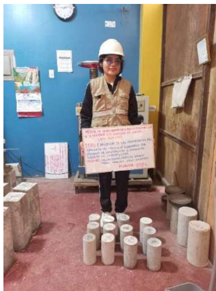
Fotografía N°39: Procedimiento de ensayo normalizado para determinar la resistencia a la compresión del concreto (NTP 339.034)
