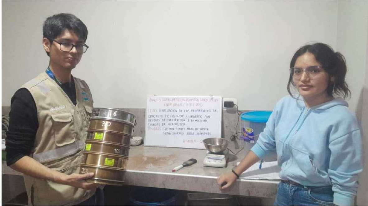
Fotografía N°22,23 y 24: Análisis granulométrico del agregado grueso y fino (NTP 400.12/MTC E-204)
