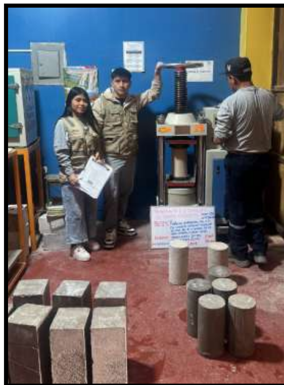
Imagen 30. Inicio a la rotura a la compresión a la edad de 28 días.
