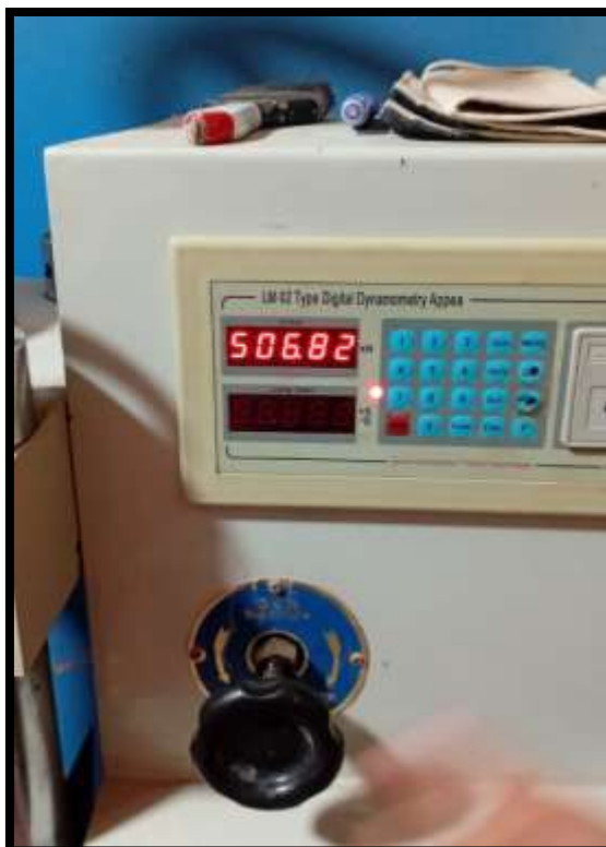
Imagen 31. Valores a la compresión de la probeta a la edad de 28 días.
