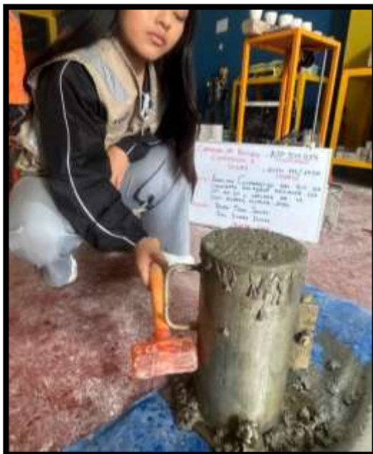
Imagen 12. Preparación de probetas de concreto cilíndricas en la evaluación experimental de compresión.
