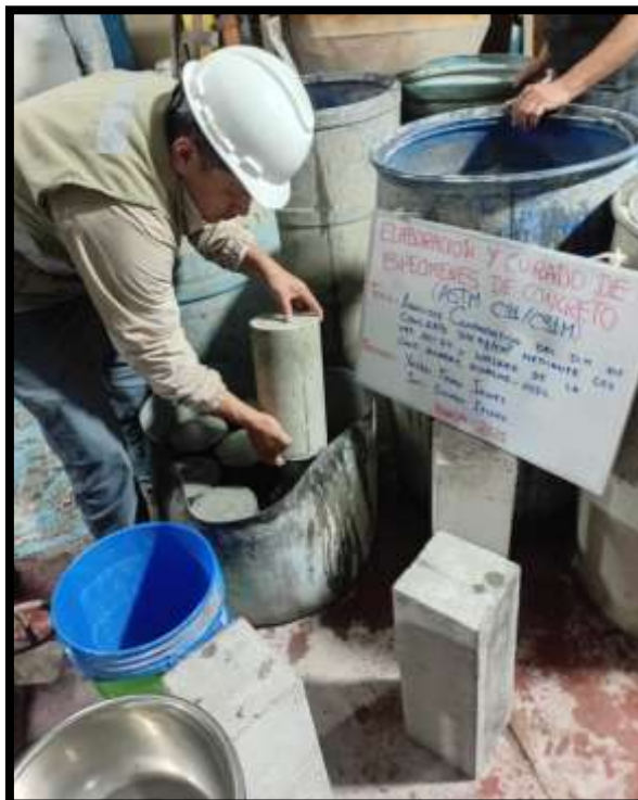
Imagen 14. Elaboración y curado de especímenes de concreto.
