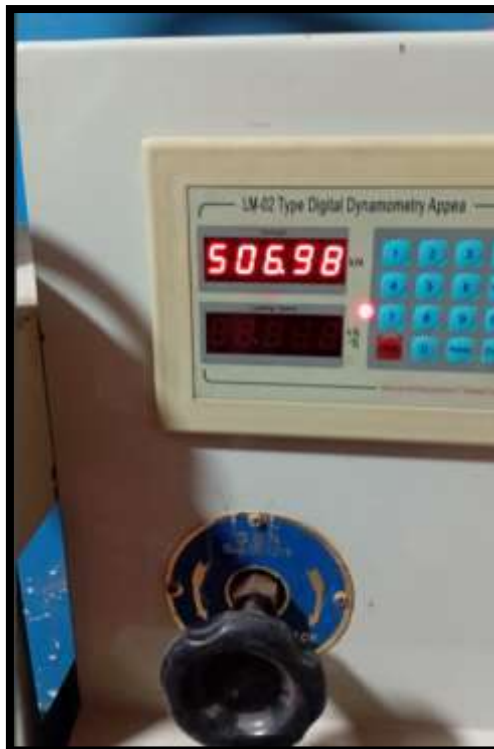
Imagen 24. Valores a la compresión de la probeta a la edad de 14 días.
