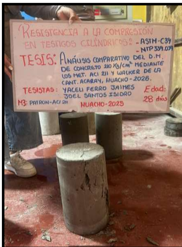
Imagen 32. Rotura a la compresión de la probeta a la edad de 28 días según el método ACI 211.
