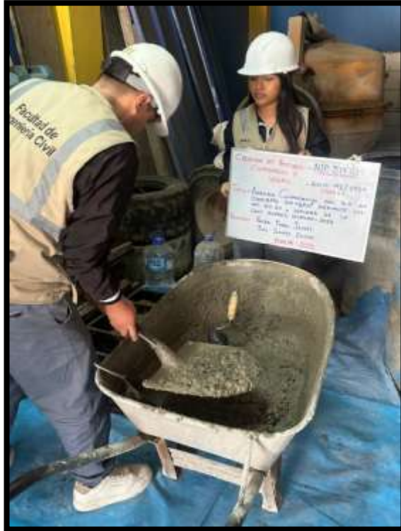
Imagen 13. Preparación de vigas de concreto para el ensayo de flexión.
