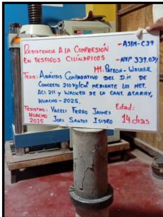
Imagen 26. Rotura a la compresión de la probeta a la edad de 14 días según el método Walker.
