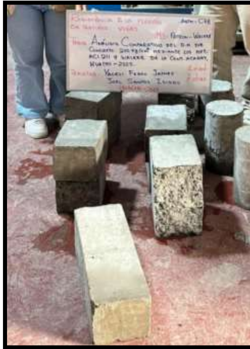
Imagen 19. Rotura a la flexión para la viga a la edad de 7 días.
