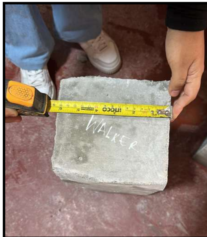
Imagen 18. Medidas para la viga antes de la rotura.
