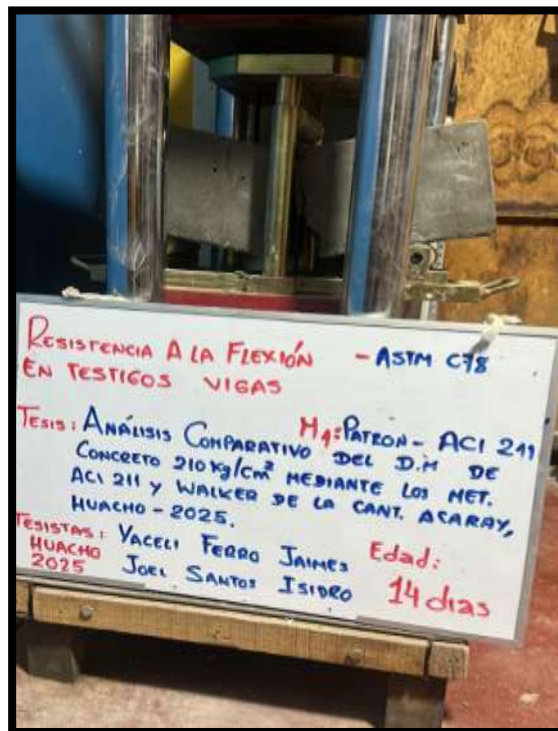
Imagen 28. Rotura a la flexión para la viga a la edad de 14 días.
