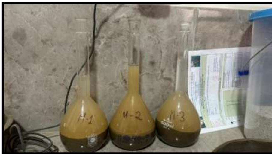
Imagen 6. Culminación para pesos unitarios y vacíos del agregado fino.
