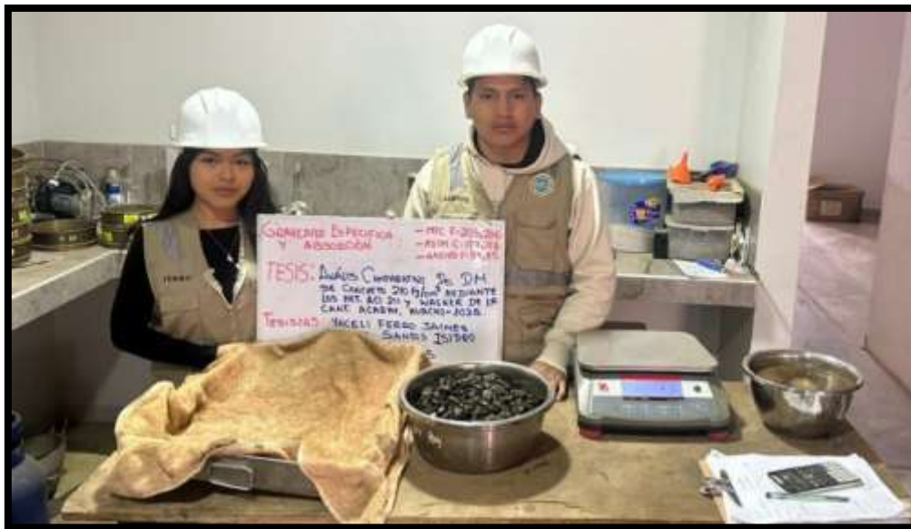
Imagen 4. Realización para la gravedad específica y absorción de los agregados
