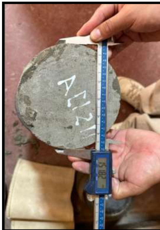
Imagen 16. Medidas para la probeta cilíndrica antes de la rotura.
