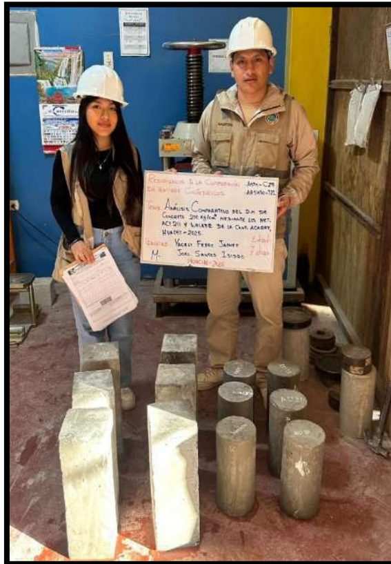
Imagen 15. Total, de muestras para la rotura de ensayo a compresión y flexión a los 7 días.
