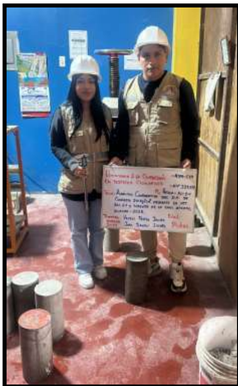
Imagen 21. Muestra para la rotura de ensayo a compresión a los 14 días.
