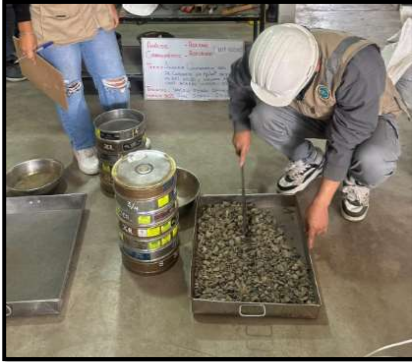
Imagen 7. Materiales para el análisis granulométrico de los agregados según NTP 400.012.
