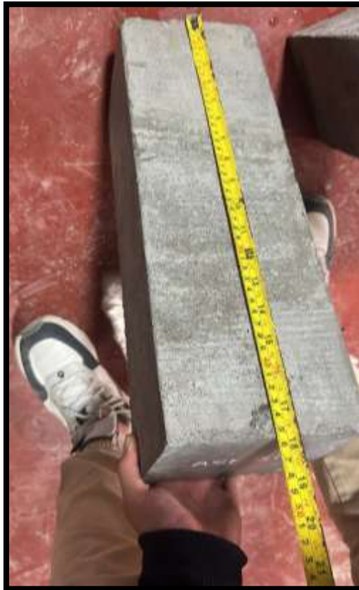
Imagen 27. Medidas a la viga antes de la rotura.
