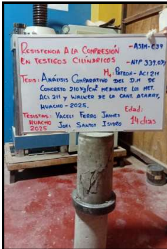
Imagen 25. Rotura a la compresión de la probeta a la edad de 14 días según el método ACI 211.
