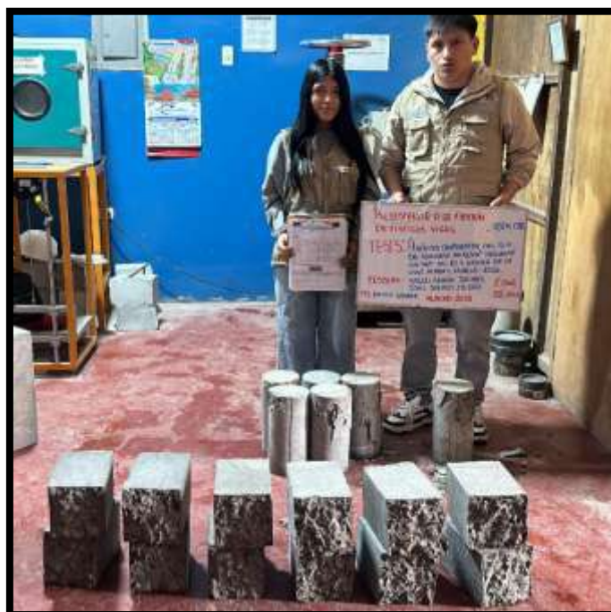
Imagen 37. Total, de roturas de probetas y vigas a la edad de 28 días.
