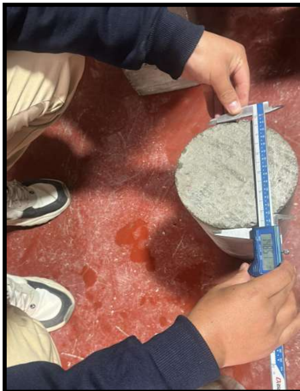
Imagen 22. Medidas para la probeta cilíndrica antes de la rotura.
