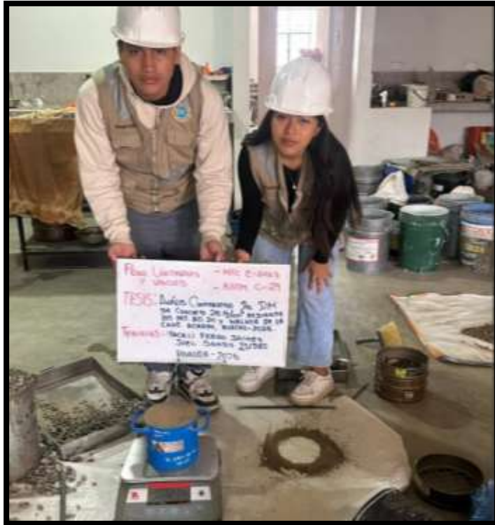
Imagen 5. Realización para pesos unitarios y vacíos de los agregados.
