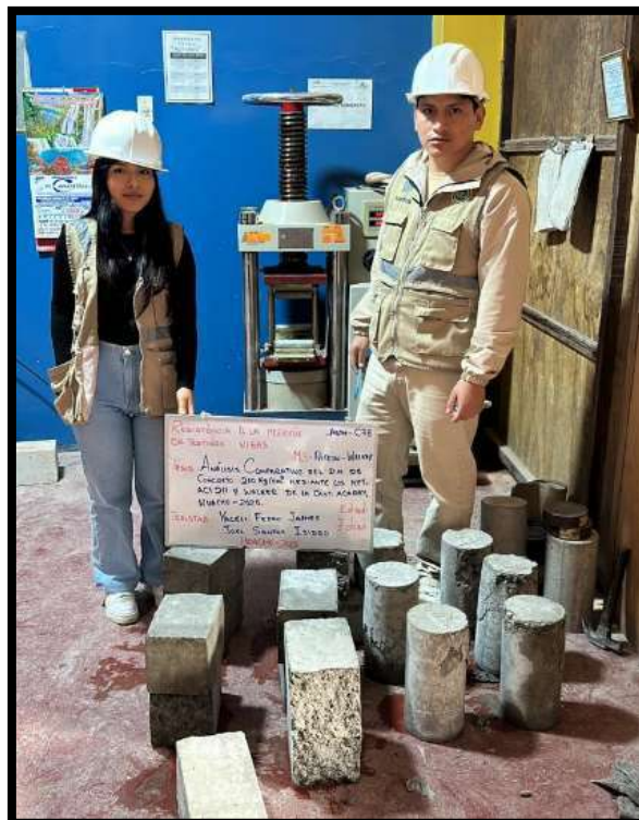
Imagen 20. Rotura final de las vigas y probetas de concreto a la edad de 7 días.
