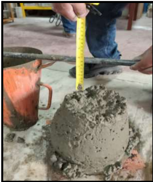
Imagen 11. Preparación mediante el cono de Abrams según el método Walker para el ensayo de consistencia.
