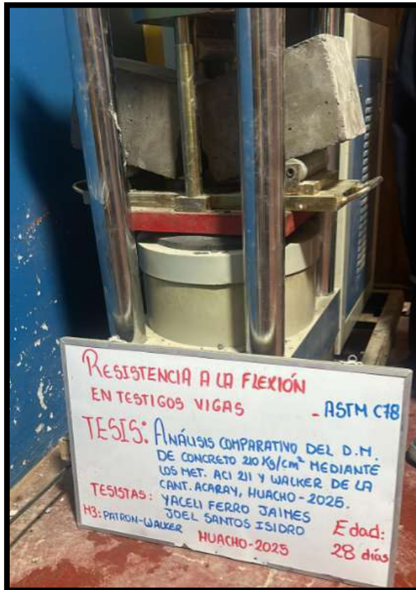
Imagen 35. Rotura a la flexión para la viga según método Walker en 28 días.
