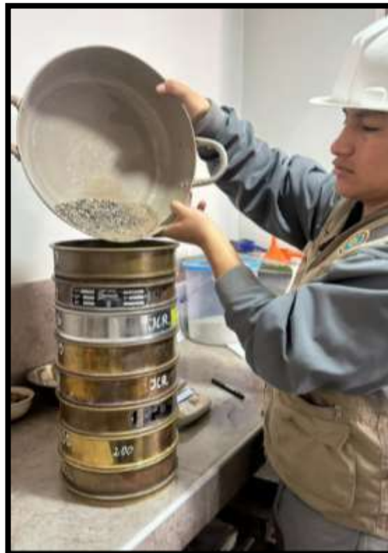
Imagen 8. Realización del análisis granulométrico de los agregados según NTP 400.012.
