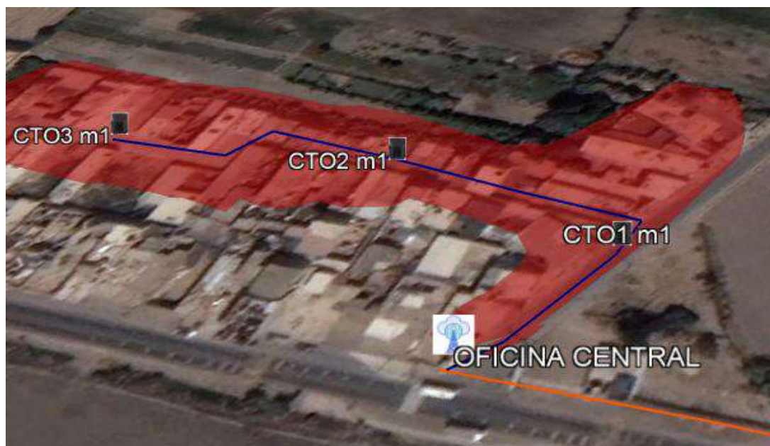
Figura 17. Zona 1: consta 3 de cajas CTOs de 16 puertos 52 viviendas
