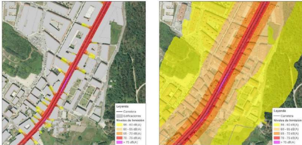
Figura 9. Distinción entre el cálculo de un modelo con obstáculos y sin ellos.
