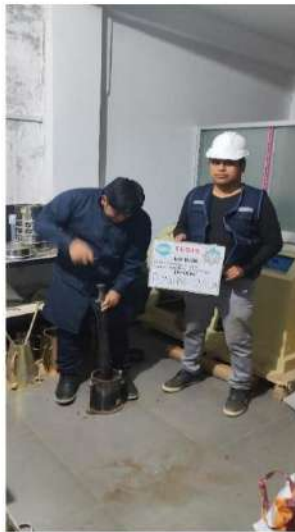
FOTOGRAFIA N°21: ENSAYO DE PROCTOR MODIFICADO AÑADIENDOLE 2% CCA
