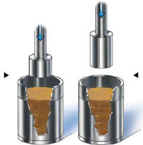
Figura 2 : El ensayo de Proctor Modificado aplica 4.5 veces el esfuerzo de compactación del ensayo de Proctor Estándar.
