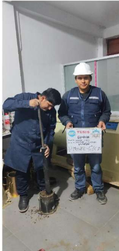
FOTOGRAFIA N°23: ENSAYO DE LIMITE LIQUIDO AÑADIENDOLE 6% CCA Se realizó el ensayo de Proctor modificado de la muestra añadiéndole 6% de ceniza de cascarilla de arroz.
