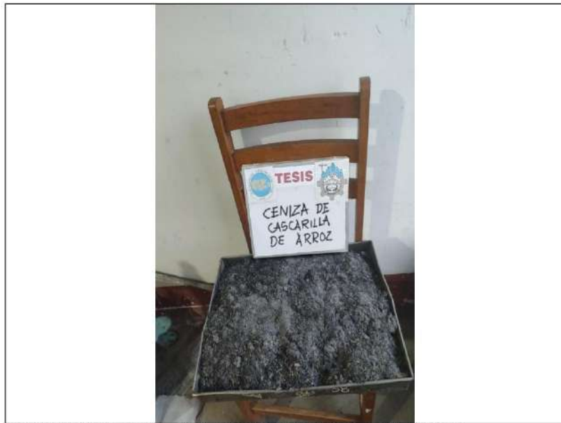
FOTOGRAFIA N°05: CENIZA DE CASCARILLA DE ARROZ Evidencia de la calcinación controlada de la cascarilla de arroz para el proyecto de tesis.
