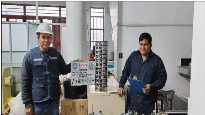
FOTOGRAFIA N°10: ENSAYO DE ANALISIS GRANULOMETRICO AÑADIENDO 4% CCA Se realizó el ensayo de análisis granulométrico de la muestra añadiéndole 4% de ceniza de cascarilla de arroz.
