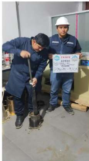
FOTOGRAFIA N°22: ENSAYO DE PROCTOR MODIFICADO AÑADIENDOLE 4% CCA
