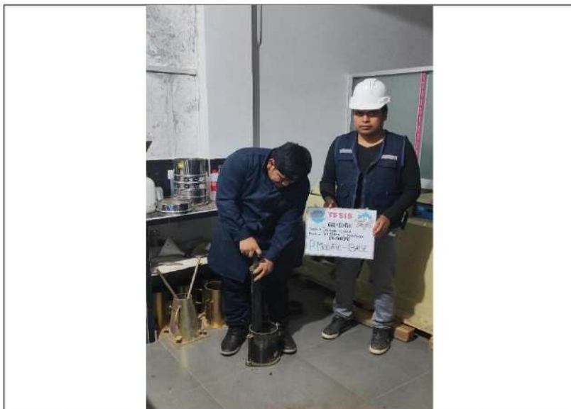
FOTOGRAFIA N°20: ENSAYO DE PROCTOR MODIFICADO (BASE) Se realizó el ensayo de proctor modificado de las muestras base extraídas de las calicatas.
