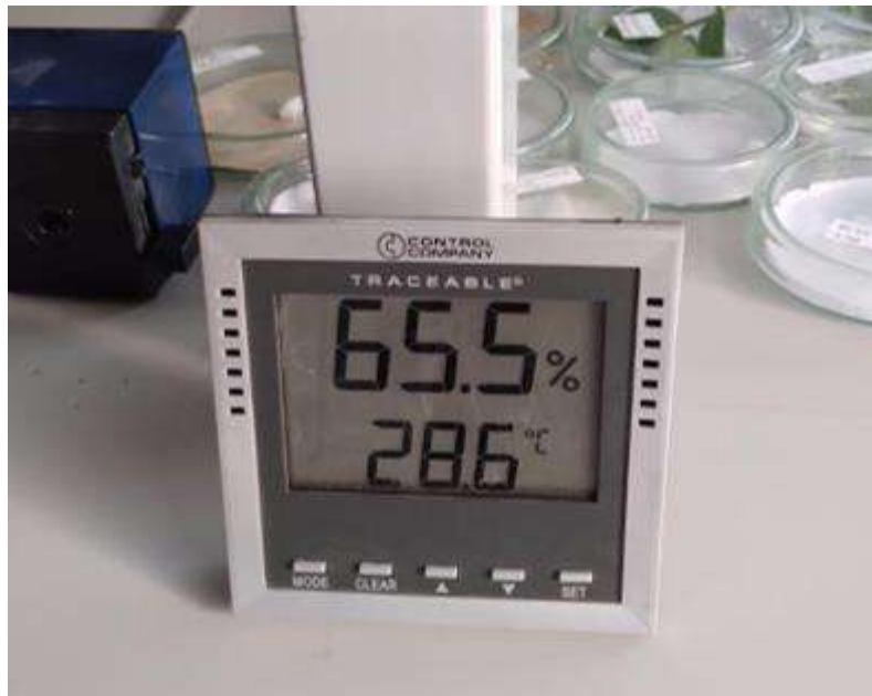
Figura 18. -Instrumento de medidas control de humedad y temperatura
