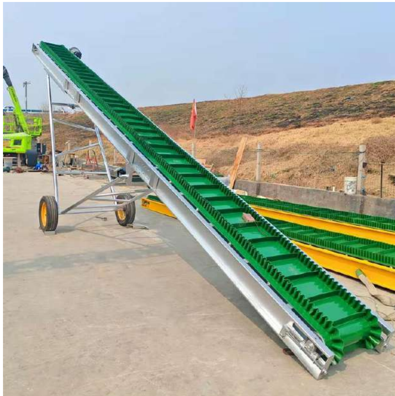
Imagen 9. Cinta transportadora Fuente: Schneider Electric
