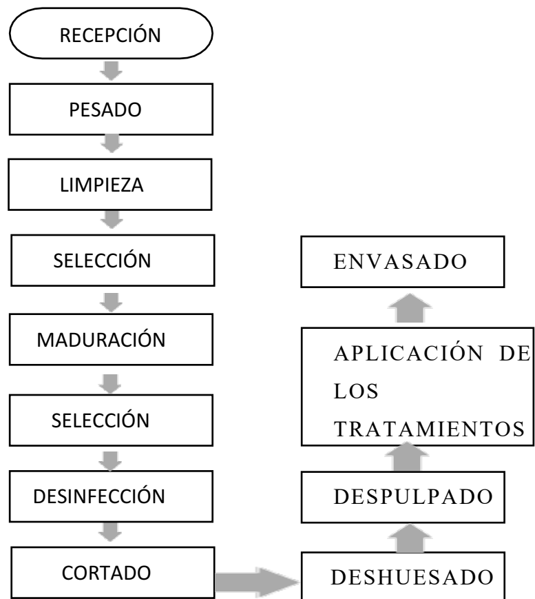
Figura 5. Diagrama de flujo para la elaboración de puré de palta con la aplicación del zumo de Citrus aurantium y Citrus limón .
