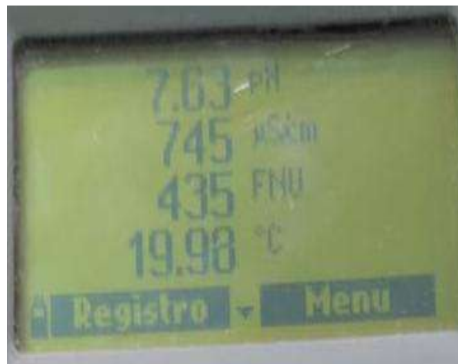
Figura 72. Tratamiento: 50 mg/L de coagulante de mango. Fuente: Propia.
