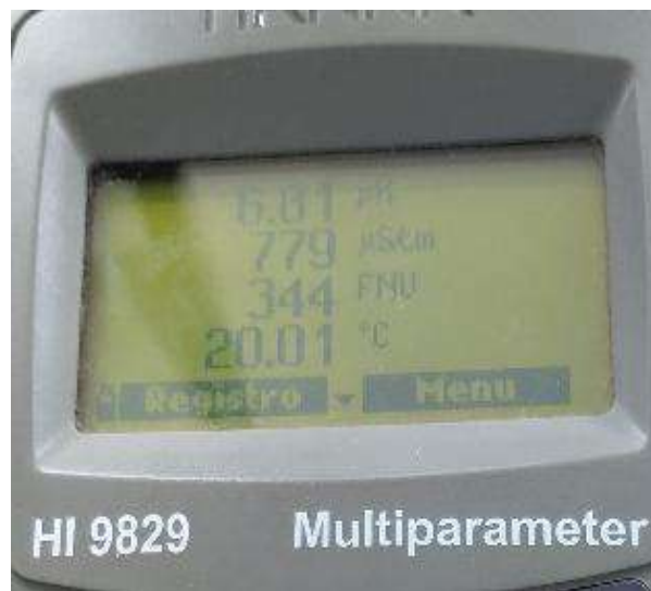
Figura 63. Tratamiento: 100 mg/L de coagulante de penca de tuna. Fuente: Propia.
