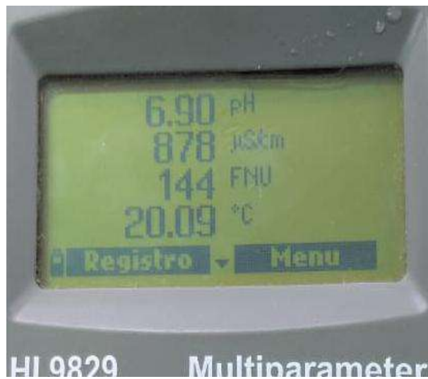
Figura 66. Tratamiento: 250 mg/L de coagulante de penca de tuna. Fuente: Propia.
