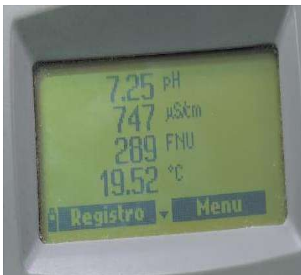
Figura 74. Tratamiento: 150 mg/L de coagulante de mango. Fuente: Propia.
