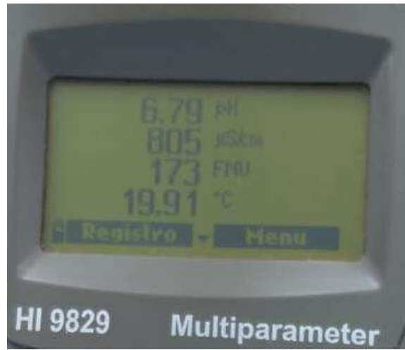
Figura 64. Tratamiento: 150 mg/L de coagulante de penca de tuna. Fuente: Propia.
