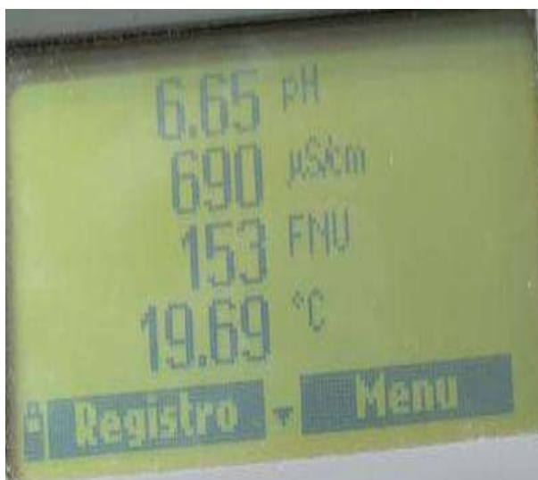
Figura 75. Tratamiento: 200 mg/L de coagulante de mango. Fuente: Propia.
