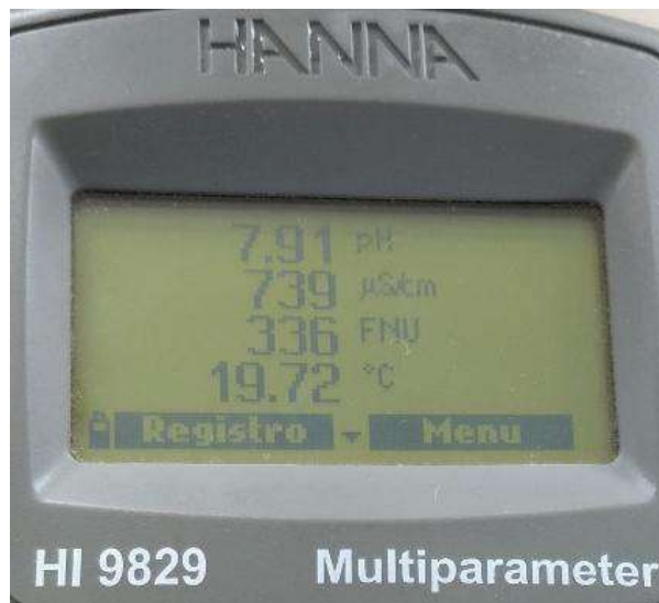
Figura 62. Tratamiento: 50 mg/L de coagulante de penca de tuna. Fuente: Propia.
