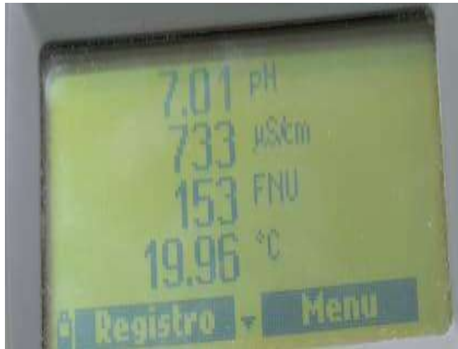
Figura 76. Tratamiento: 250 mg/L de coagulante de mango. Fuente: Propia.
