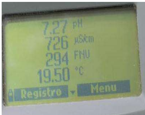
Figura 73. Tratamiento: 100 mg/L de coagulante de mango. Fuente: Propia.
