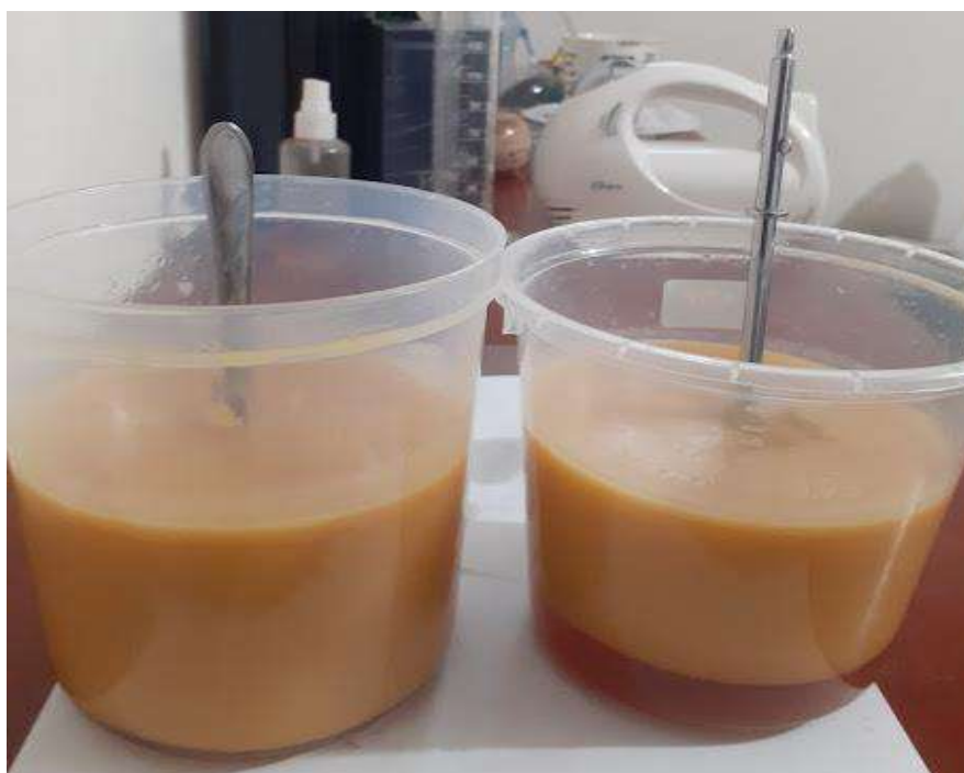
Figura N° 26. Mezclado en proporciones estequiométricas para obtención de jabones ecológicos.
