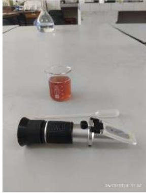
*Refractómetro, muestra y pipeta Pasteur.*
