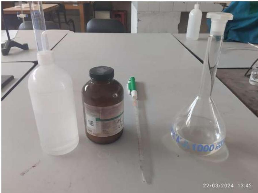
*Agua destilada, biftalato de potasio, pipeta e hidroxido de sodio sin estandarizar.*
