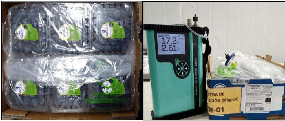
Figura 40. Medición de Concentración de O 2 – CO 2
