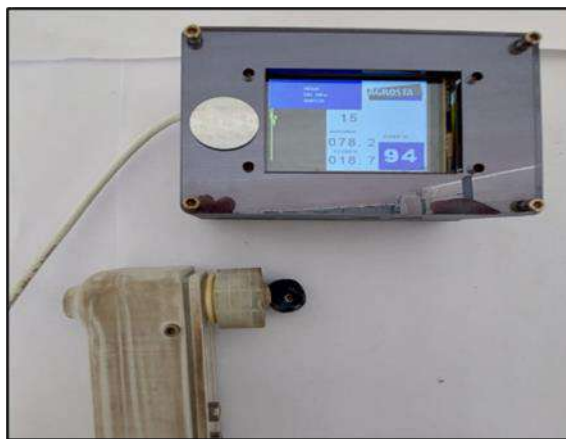
Figura 38. Equipo Durofell para medir FIRMEZA
