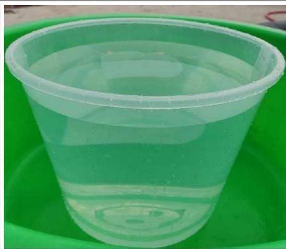
*Figura 37.* Balde plástico transparente graduado de 12 litros.
