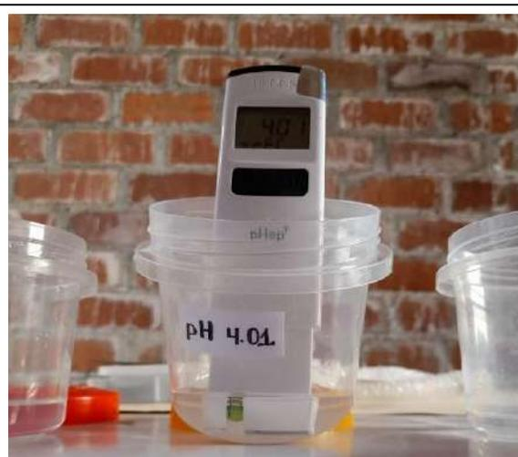
*Figura 32.* Calibración de tester de pH y temperatura.
