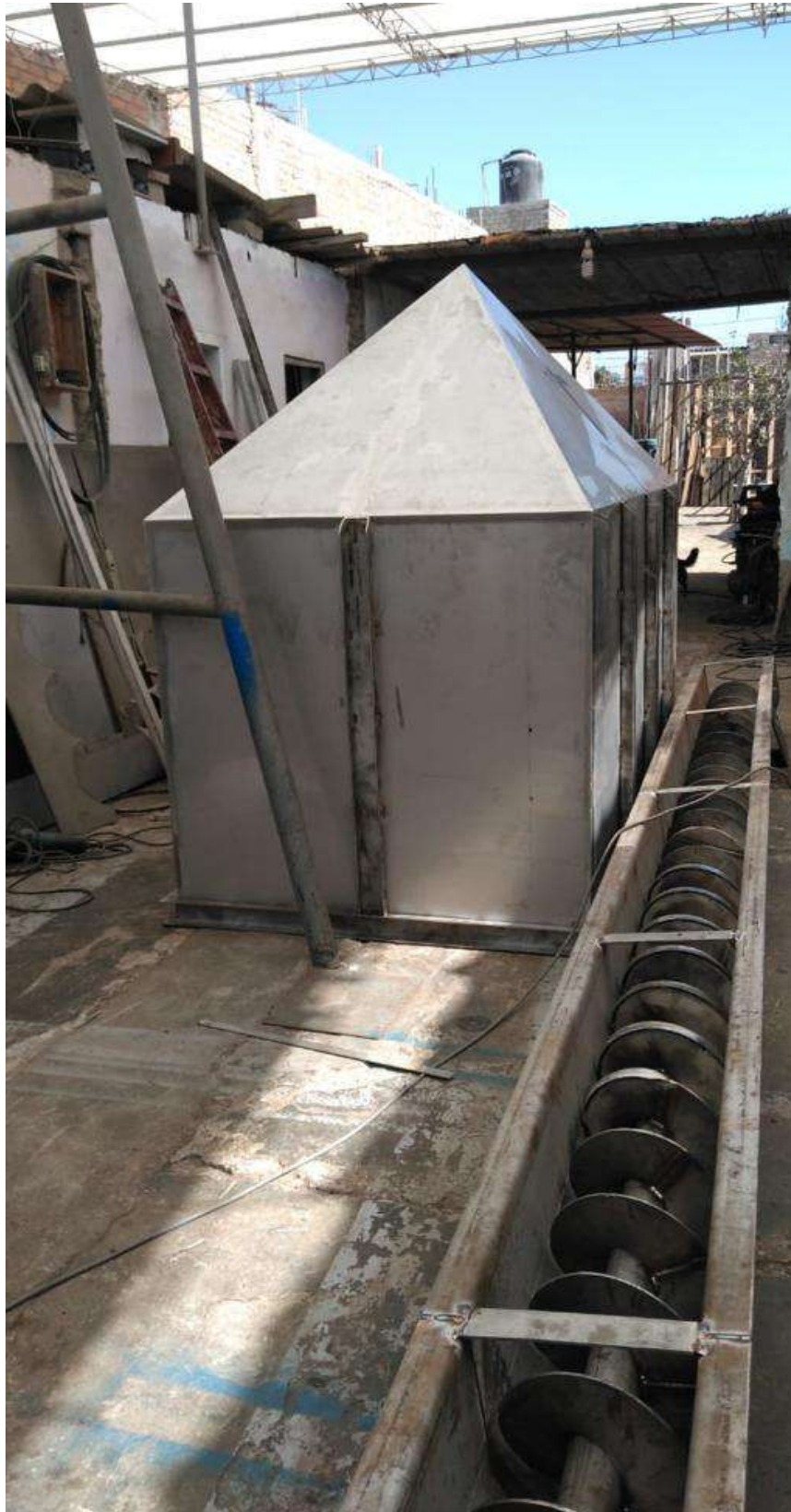
Figura 5. Detalle del gusano helicoidal para el transporte de scrap salida del purificador.
