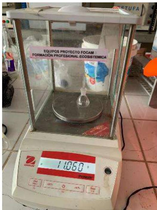
Figura 5. Peso del picnómetro vacío.
