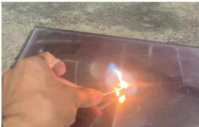
*Figura 13.* Punto de Inflamación del combustible obtenido.
