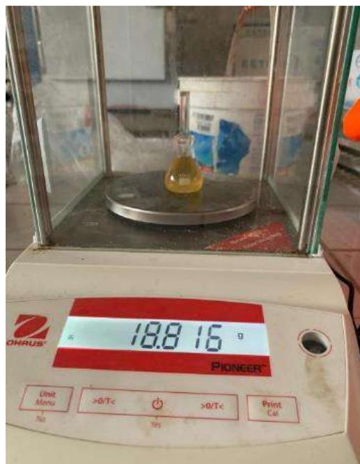
Figura 6. Peso del picnómetro con la muestra.
