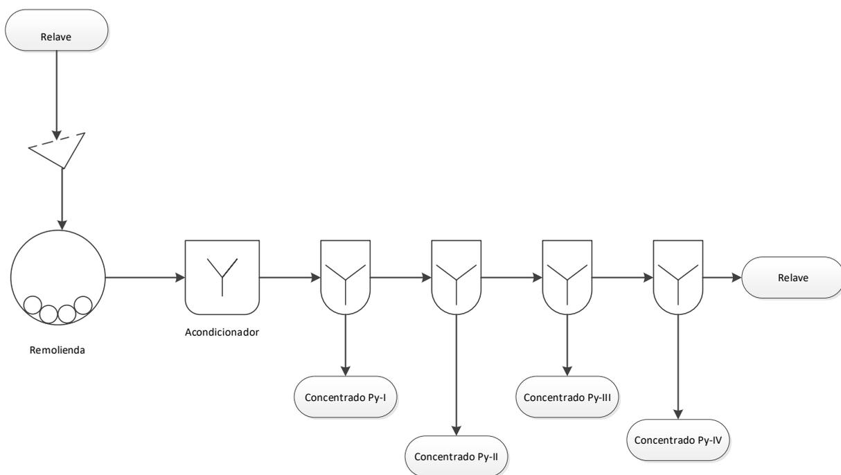
En la figura que antecede 1 se tiene el circuito de las pruebas de clasificación, molienda de relave, acondicionamiento, flotación Py-I, Flotación Py-II, flotación Py-III, flotación Py-IV.
