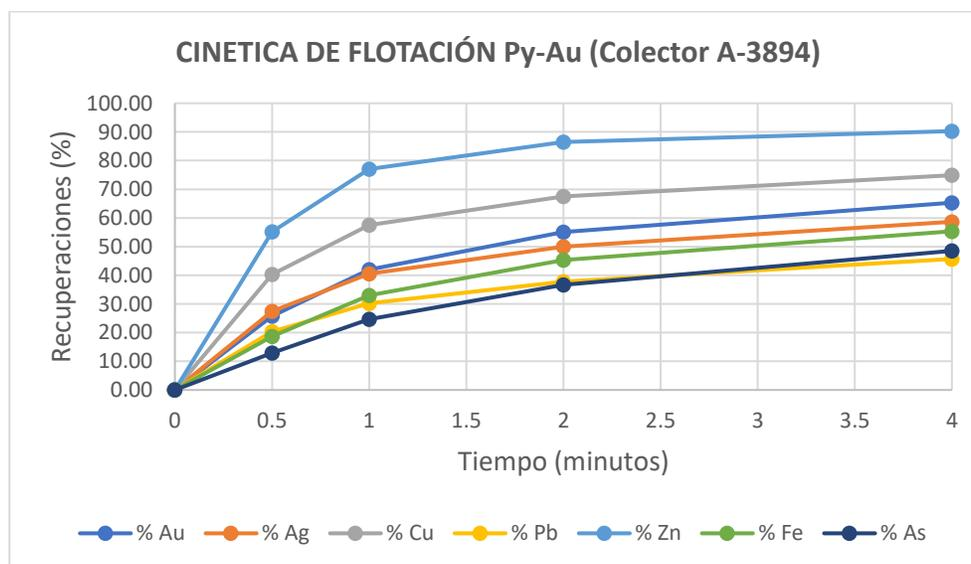
La curva de recuperación en la flotación en la figura 8 para el oro y plata tiende a crecer.
