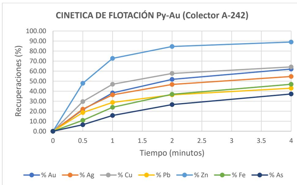
En la figura 4 la curva de cinética de flotación en la recuperación de Au, Ag, Cu, Pb, Zn, Fe, As en la prueba con A-242.
