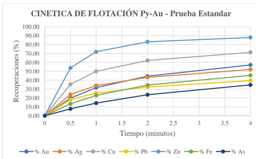
Se tiene la curva de la cinética de la flotación en la recuperación de oro, plata, cobre, plomo, zinc, hierro y arsénico en la figura 3.
