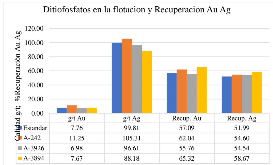
En la tabla 19 y la figura 10 respecto la hipótesis alternativa predetermina para el ditiofosfato el A-242 en la calidad y en la recuperación el A-3894.
