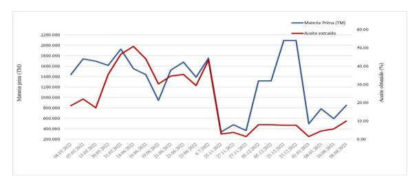
En figura 3 se muestra cómo varían la materia prima de anchoveta procesada y las toneladas métricas de aceite producidas en función de la fecha de producción. En el eje x se representa la fecha de producción, mientras que en el eje y se representarán las toneladas métricas de materia prima de anchoveta procesada y de aceite producido.
