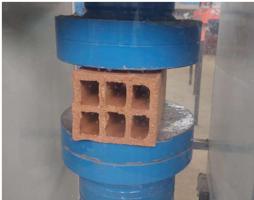
Foto N° 01 Resistencia a compresión ladrillo pandereta
