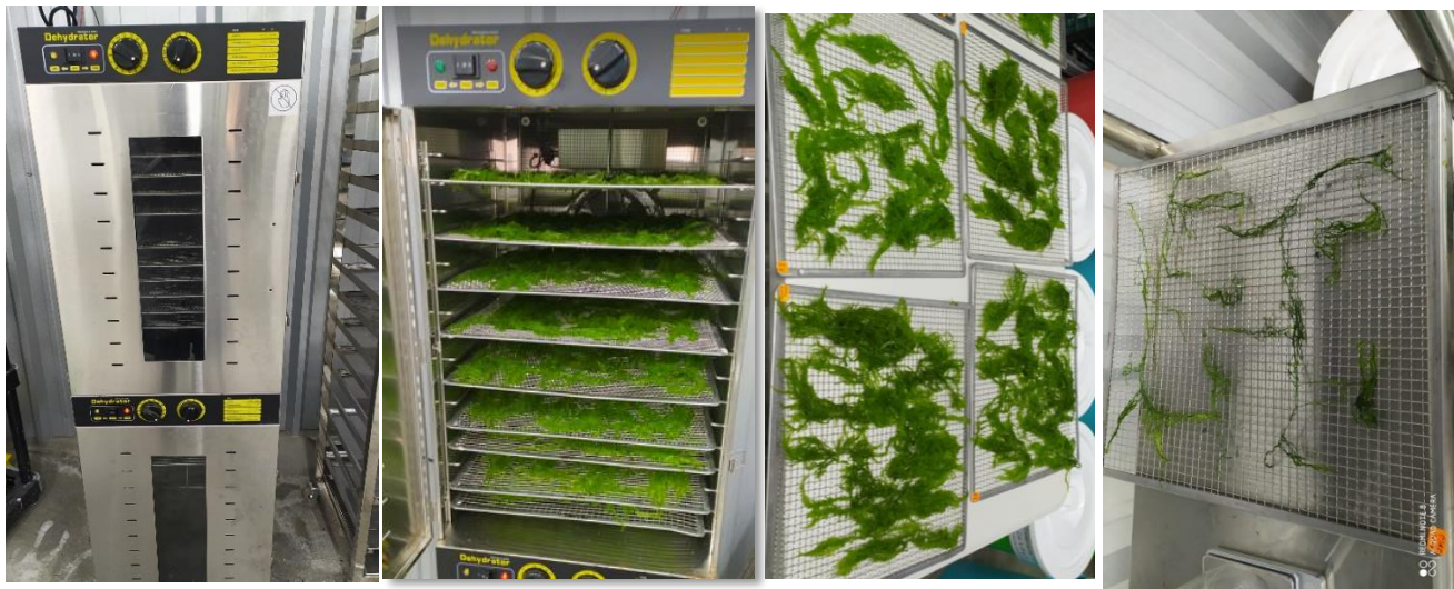
Anexo 14. Deshidratado de suginori verde 2 horas a una temperatura de 50°C y 3 horas a 70°C.
