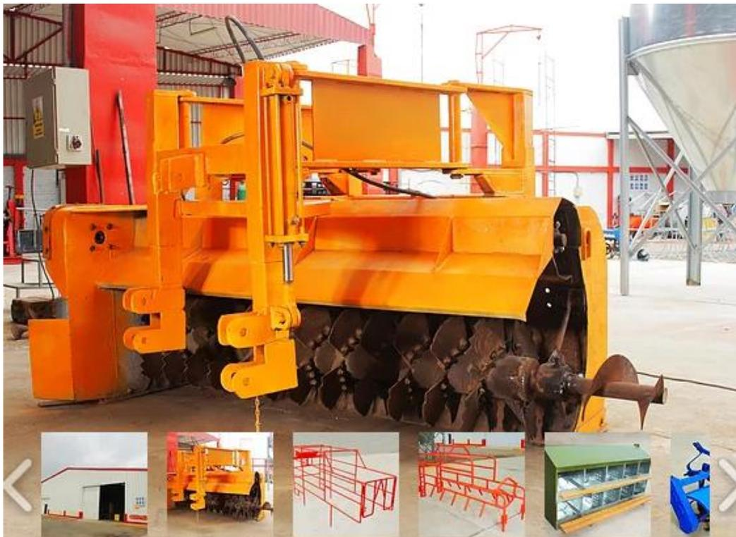
*Figura 6.* Máquina compostadora para el tratamiento de residuos orgánicos.
