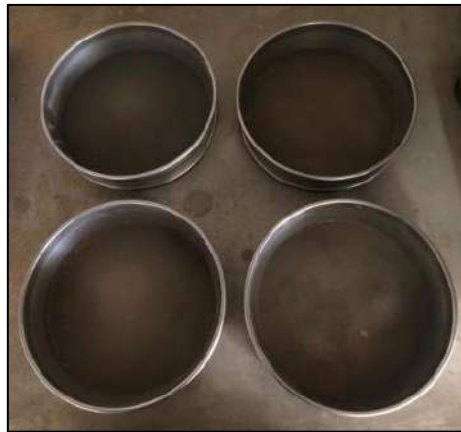
Figura 20. Mallas con diferentes MESH. Fuente: Laboratorio de la E.P.I.M.
