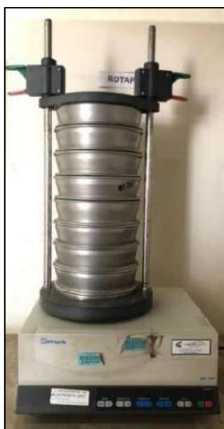
Figura 19. Secuencia de orden en los tamices. Fuente: Laboratorio de la E.P.I.M.
