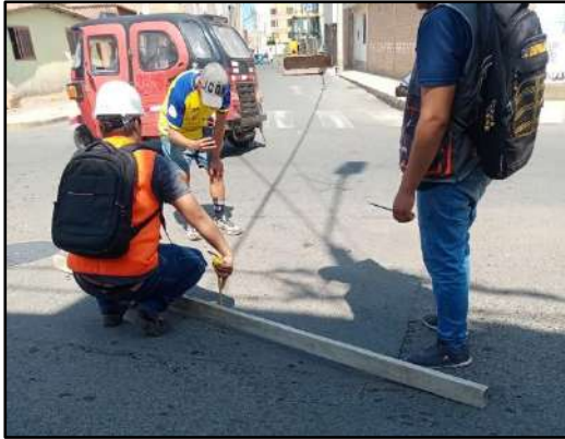
Fotografía 1: Identificación de grieta longitudinal.
