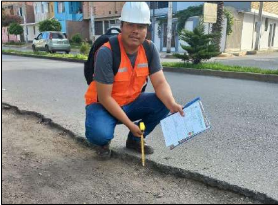
Fotografía 8: Espesor del pavimento en campo
