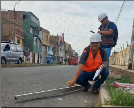
Fotografía 7: Identificación de fallas tipo Ahuellamiento.
