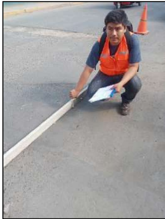
Fotografía 4: Identificación de fallas tipo piel de cocodrilo.
