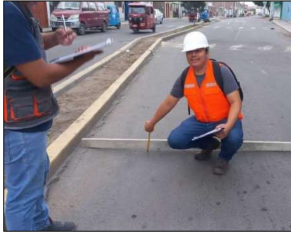
Fotografía 7: Identificación de fallas tipo Ahuellamiento.
