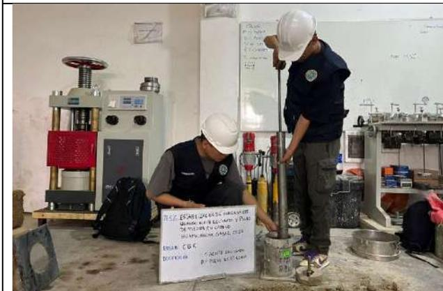
Figura 61. Ensayo de CBR del suelo de subrasante natural, apisonado de muestra M-01 dentro del molde para ensayos de CBR.
