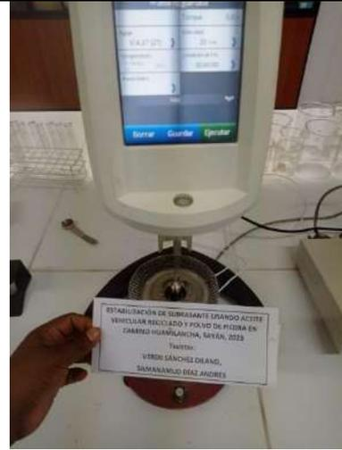
Figura 78. Ensayo de viscosidad del aceite vehicular reciclado
