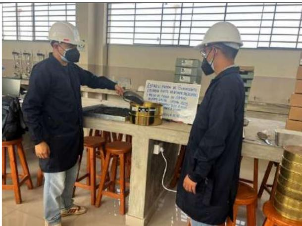
Figura 73. Ensayo de Abrasión al Desgaste, separación de muestra según el tamiz N°10
