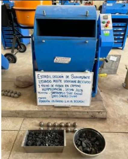
Figura 71. Ensayo de Abrasión al Desgaste, muestra antes de su ingreso a la máquina de Los Ángeles
