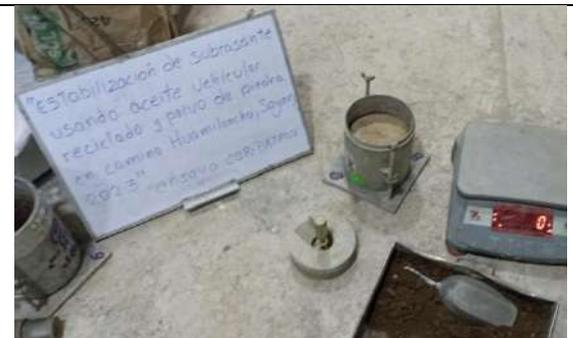
Figura 62. Ensayo de CBR de la subrasante inalterada, molde con la muestra M-01 preparado para ingresar a la máquina para ensayos de CBR
