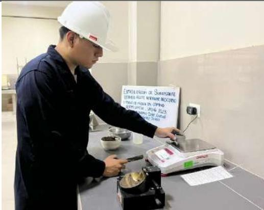
Figura 51. Ensayo de LL del suelo de subrasante natural, pesaje de la muestra húmeda luego de realizado el ensayo
