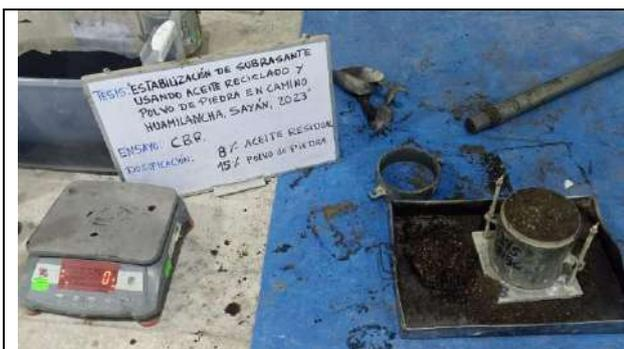
Figura 95. Ensayo de CBR de suelo de subrasante natural adicionando AVR y PP, molde con la muestra M-05 preparado para ingresar a la máquina para ensayos de CBR
