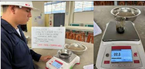
Figura 81. Ensayo de límite líquido, límite plástico e índice de plasticidad de suelo de subrasante natural adicionando AVR y PP, pesaje de agregados necesarios para el ensayo
