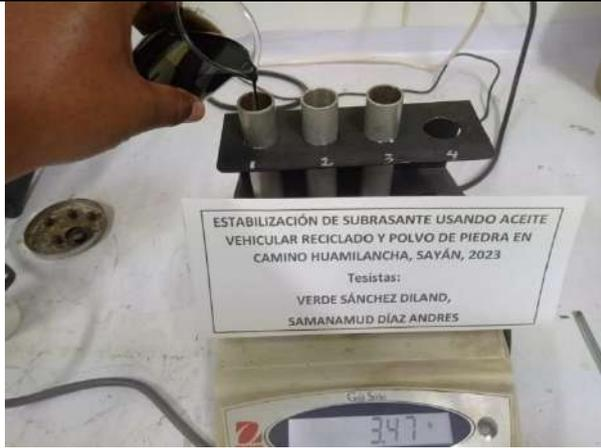
Figura 77. Ensayo de viscosidad del aceite vehicular reciclado
