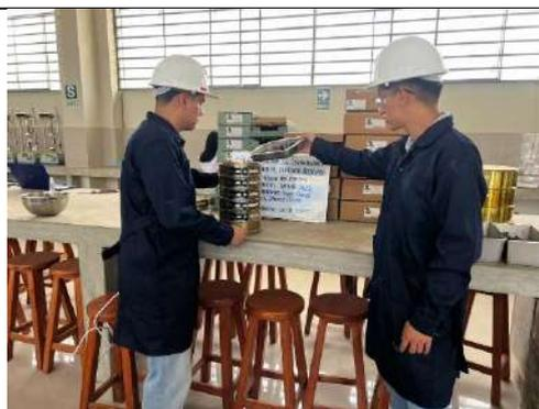
Figura 70. Ensayo de Abrasión al Desgaste, tamizaje de muestra según la gradación A en agregados gruesos de tamaños menores
