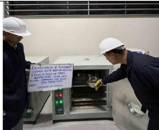
Figura 46. Ensayo de CH del suelo de subrasante natural, retiro de muestra del horno
