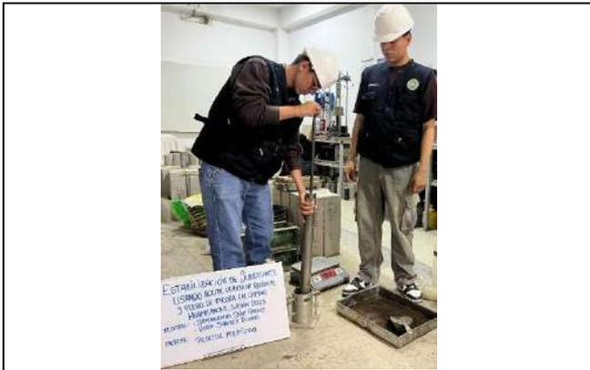
Figura 59. Ensayo de Proctor modificado del suelo de subrasante natural, compactación de la muestra mediante pisón
