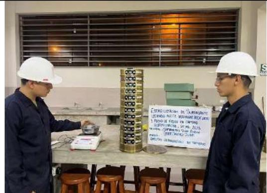
Figura 42. Ensayo de Granulometría del suelo de subrasante natural, peso de muestra inicial
