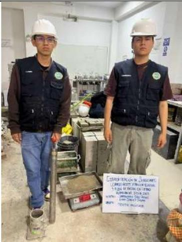
Figura 55. Ensayo de Proctor modificado del suelo de subrasante inalterada, pesaje de la muestra
