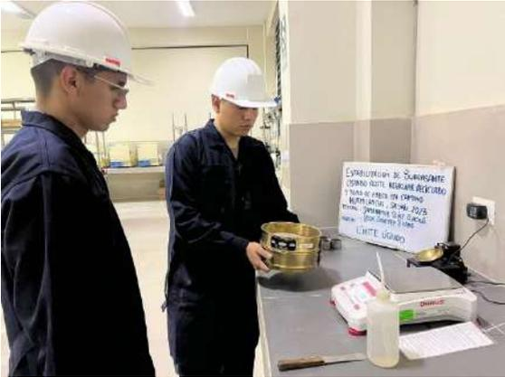
Figura 47. Ensayo de LL del suelo de subrasante natural, obtención de material pasante del tamiz N° 40.
