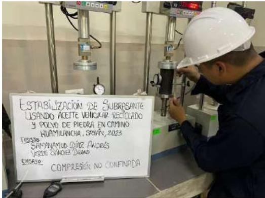
*Figura 101.* Ensayo de RCNC de suelo de subrasante natural adicionando AVR y PP, medición de altura y diámetro de espécimen M-02
