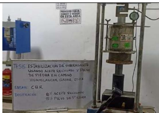
Figura 96. Ensayo de CBR de suelo de subrasante natural adicionando AVR y PP, máquina manual para ensayos de CBR con la muestra M-05 en su interior
