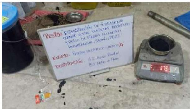
Figura 91. Ensayo de Proctor modificado de suelo de subrasante natural adicionando AVR y PP, pesaje de polvo de piedra necesario para obtener la muestra M-03
