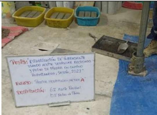
Figura 89. Ensayo de Proctor modificado de suelo de subrasante natural adicionando AVR y PP, compactación de la muestra M-02 mediante pisón
