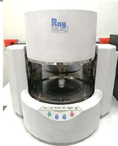
Figura 80. Espectrómetro de fluorescencia de Rayos X de energía dispersiva utilizado para obtener los componentes químicos del polvo de piedra.
