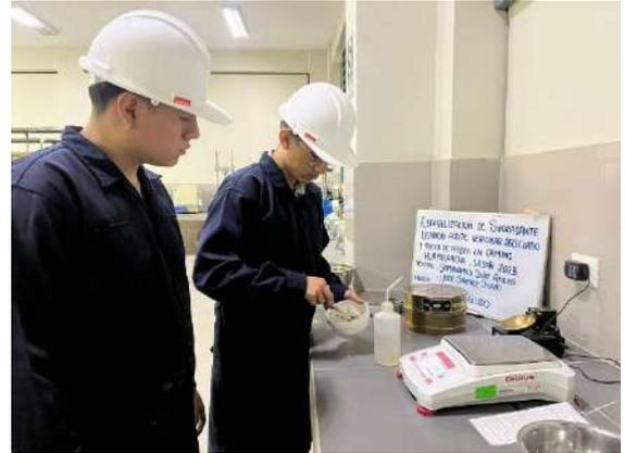
Figura 48. Ensayo de LL del suelo de subrasante natural, mezcla de la muestra de suelo con agua
