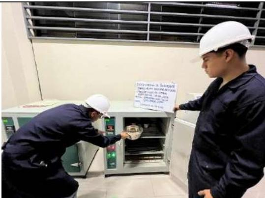
Figura 45. Ensayo de CH del suelo de subrasante natural, introducción de muestra al horno a 110°C
