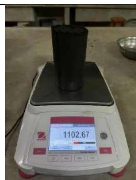
Figura 100. Ensayo de RCNC de suelo de subrasante natural adicionando AVR y PP, pesaje de espécimen compactado M-02 (con adición de 6% AVR + 10% PP)
