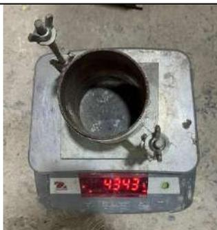
Figura 57. Ensayo de Proctor modificado del suelo de subrasante inalterada, pesaje de la probeta
