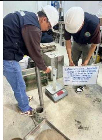
Figura 56. Ensayo de Proctor modificado del suelo de subrasante inalterada, pesaje del agua agregada
