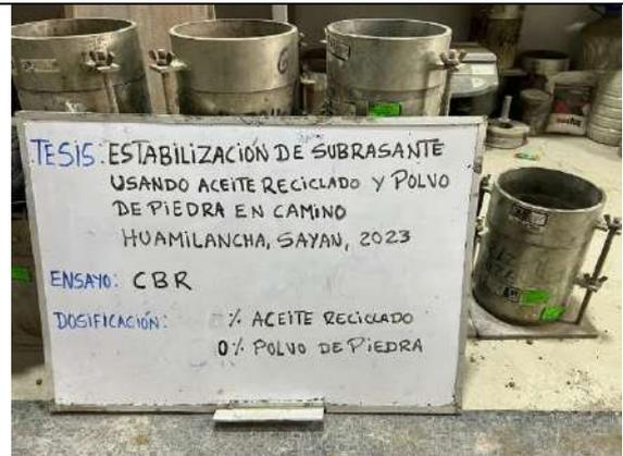
Figura 60. Ensayo de CBR del suelo de subrasante natural, moldes para ensayos de CBR
