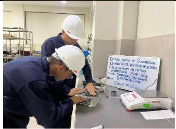
Figura 52. Ensayo de LP del suelo de subrasante natural, obtención de varillas de 3.2 mm de diámetro
