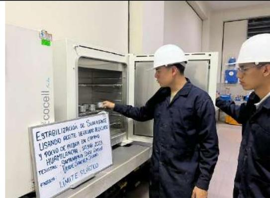
Figura 54. Ensayo de LL y LP del suelo de subrasante natural, secado de las muestras en horno a 110°C
