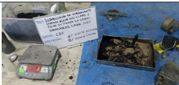
Figura 93. Ensayo de CBR de suelo de subrasante natural adicionando AVR y PP, mezclado de suelo con los agentes estabilizadores para obtener la muestra M-05
