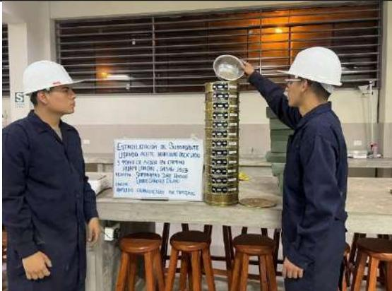
Figura 43. Ensayo de Granulometría del suelo de subrasante natural, introducción de muestra en la serie de tamices
