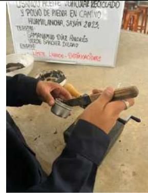
Figura 84. Ensayo de IP, LP y LL de suelo de subrasante natural adicionando AVR y PP, almacenamiento de muestra húmeda para el horno
