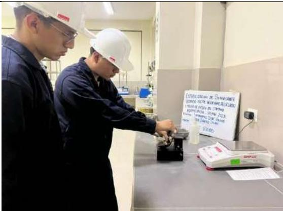
Figura 49. Ensayo de LL del suelo de subrasante natural, uso del acanalador para dividir la muestra en la copa de Casagrande
