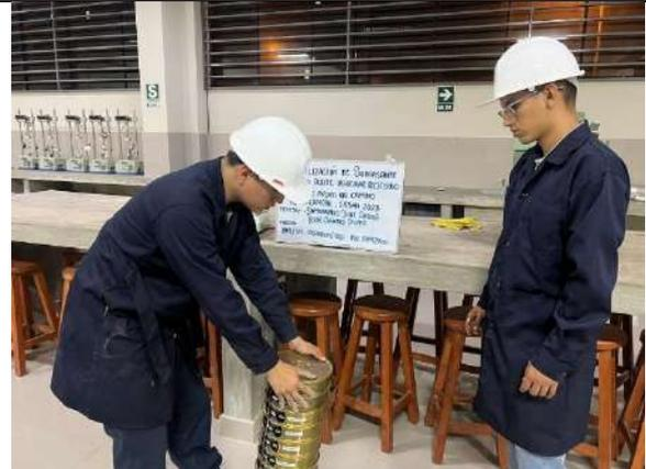
Figura 44. Ensayo de Granulometría del suelo de subrasante natural, tamizado manual
