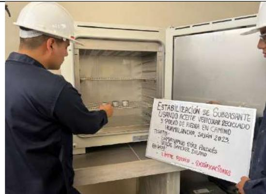
Figura 86. Ensayo de IP, LP y LL de suelo de subrasante natural adicionando AVR y PP, colocado de muestras en el horno a 110°C
