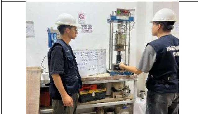
Figura 63. Ensayo de CBR del suelo de subrasante natural, máquina manual para ensayos de CBR con la muestra M-01 en su interior
