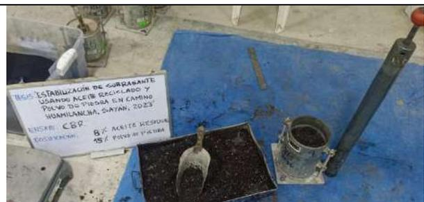
Figura 94. Ensayo de CBR de suelo de subrasante natural adicionando AVR y PP, compactación de muestra M-05 dentro del molde de ensayo CBR mediante apisonamiento
