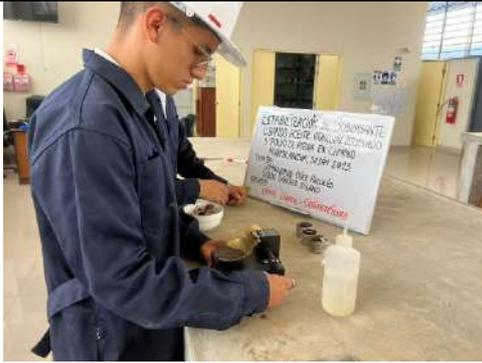
Figura 83. Ensayo de IP, LP y LL de suelo de subrasante natural adicionando AVR y PP, conteo de número de golpes en la copa de Casagrande
