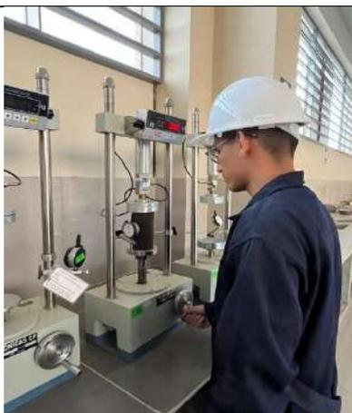
Figura 67. Ensayo de RCNC del suelo de subrasante natural, aplicación de carga manual
