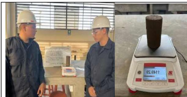
Figura 65. Ensayo de RCNC del suelo de subrasante natural, peso del espécimen compactado
