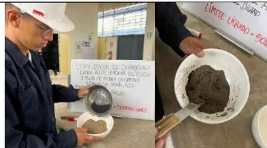
Figura 82. Ensayo de IP, LP y LL de suelo de subrasante natural adicionando AVR y PP, mezclado de agregados y suelo
