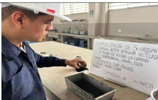
Figura 99. Ensayo de c RCNC de suelo de subrasante natural adicionando AVR y PP, vertido de aceite vehicular reciclado a la mezcla de suelo-polvo de piedra
