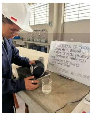
Figura 98. Ensayo de RCNC de suelo de subrasante natural adicionando AVR y PP, mezclado del suelo con el polvo de piedra
