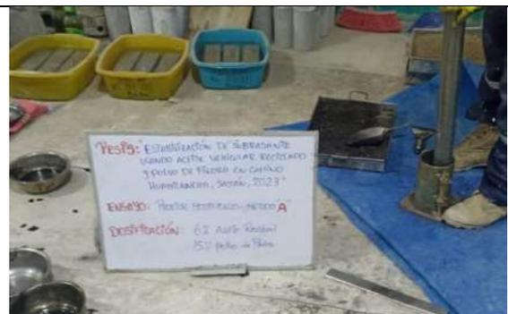
Figura 92. Ensayo de Proctor modificado de suelo de subrasante natural adicionando AVR y PP, compactación de la muestra M-03 mediante pisón
