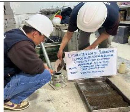
Figura 58. Ensayo de Proctor modificado del suelo de subrasante inalterada, vertido de la segunda capa de muestra en el interior de la probeta
