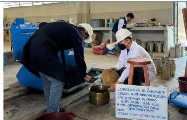
Figura 74. Obtención de polvo de piedra por tamizado, colocación de muestra resultante luego de pasar por la máquina de Los Ángeles dentro del tamiz N°40
