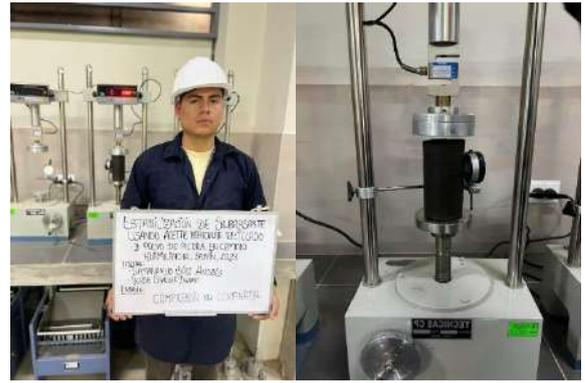
*Figura 102.* Ensayo de RCNC de suelo de subrasante natural adicionando AVR y PP, colocación de espécimen M-02 dentro de la máquina de compresión
