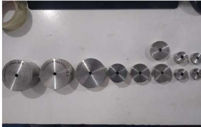
Pesas de diferentes cargas para uso en la máquina de pruebas de resistencia en recubrimientos.
