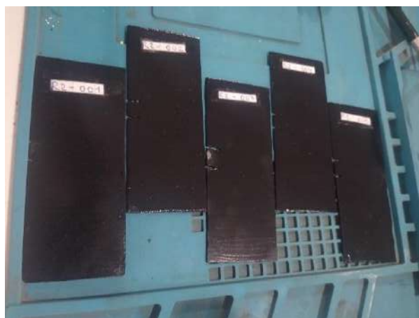
Figura 44: Paneles de prueba pintados. Fuente: Elaboración propia.
