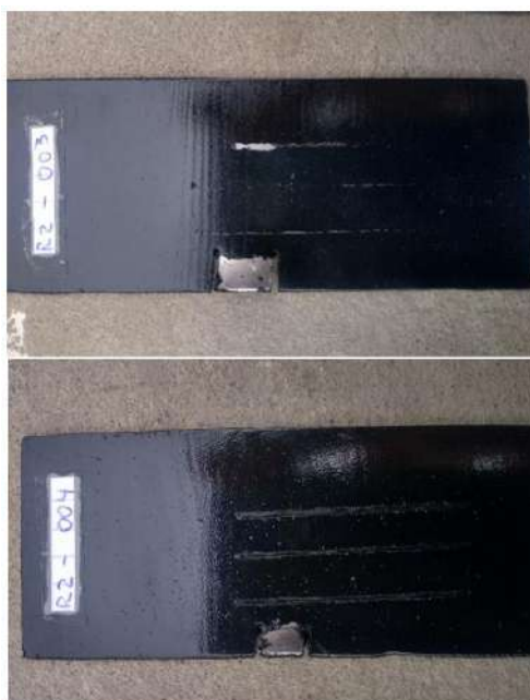
Figura 52: Placas de prueba (probetas) con recubrimiento 1 después de las pruebas realizadas. Fuente: Elaboración propia
