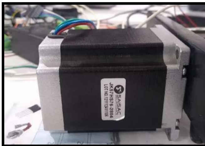
Figura 28: Motor PAP Nema 23 JK57HS76-2804. Fuente: Elaboración propia
