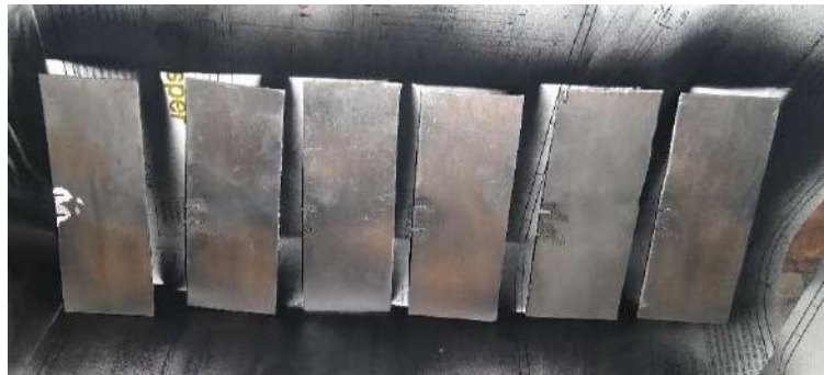
Figura 43: Paneles de prueba de 4cm x 10cm cortados y lijados. Fuente: Elaboración propia.
