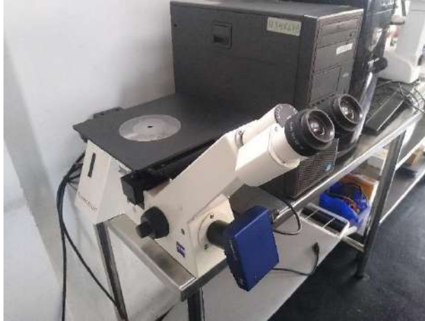
Microscopio óptico Carl Zeiss, usado para inspección visual, se usó varios aumentos, según norma se debe observar un al menos un lente de mínimo 5 aumentos.
