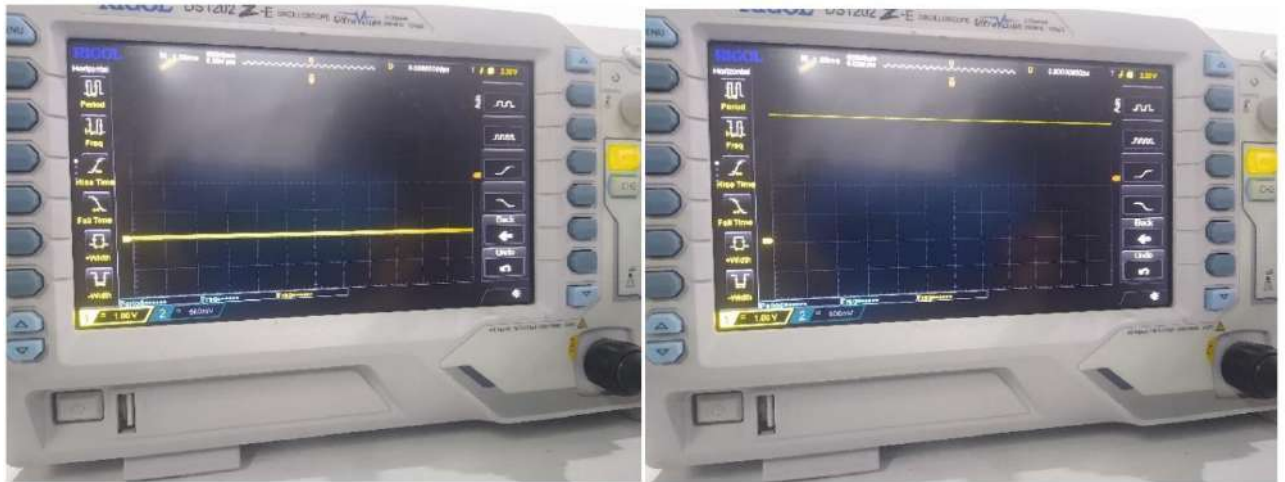
Osciloscopio mostrando salida de uno de los pines del MCU, el cual activa el buzzer la muestra una medida cercana a 5V al momento de su activación
