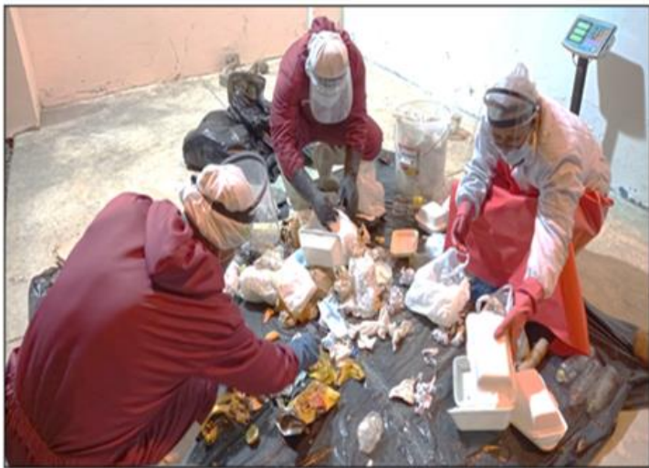
Foto4. Determinación de la composición de residuos sólidos
