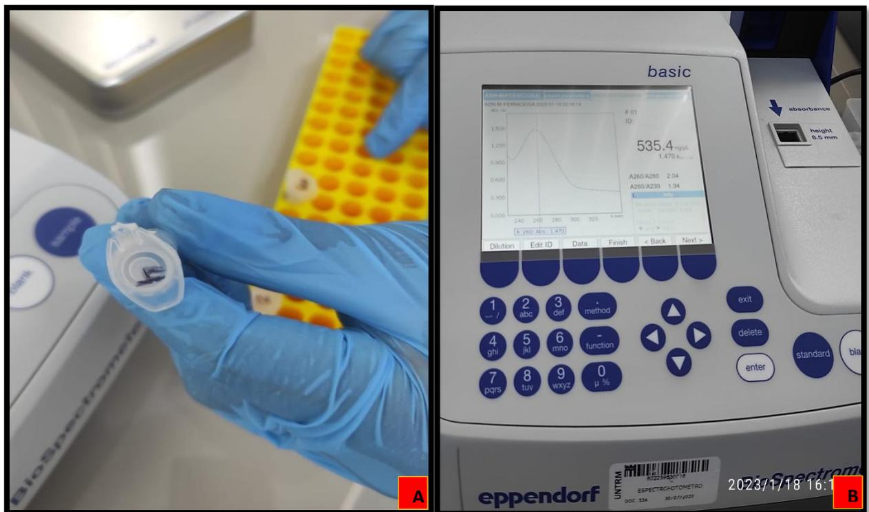
Figura 19: Extracción y cuantificación de DNA microbiano A: Muestra de DNA genómico B: Cuantificación en bioespectrofotometro.
