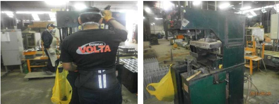
*Figura 17.* Sellado térmico de celdas.
