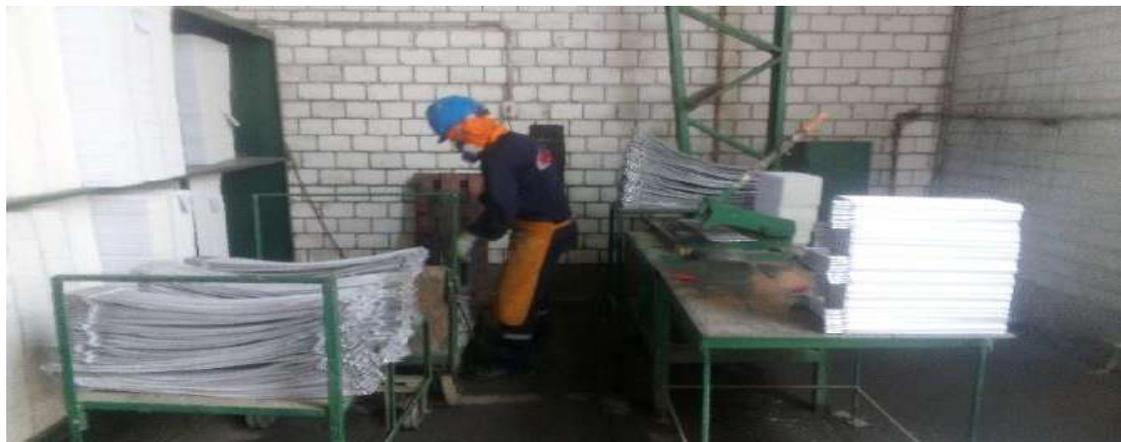
*Figura 11.* Corte de placas positivas y colocación de gauntlets.
