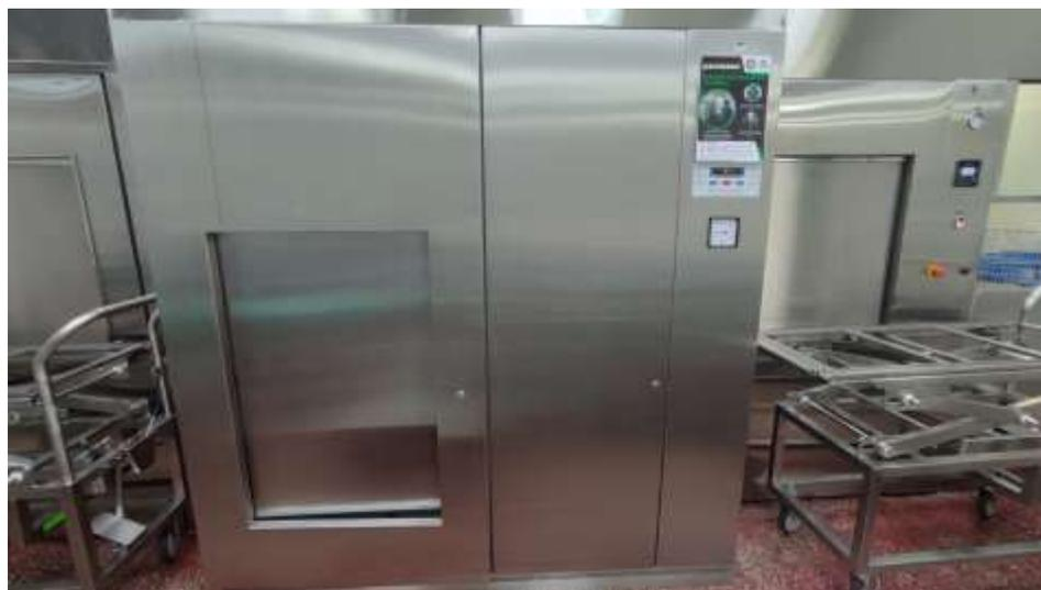
**Figura 3.** Esterilizador STERIVAP con generador eléctrico de vapor dos puertas
