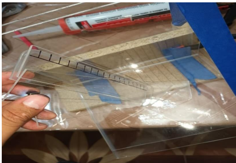
Figura 4. Colocación de las planchas acrílicas para el soporte y fijación de los electrodos.
