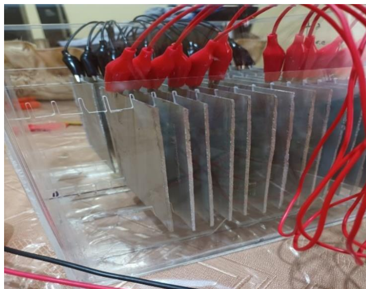
Figura 8. Conexión de los electrodos con la fuente de poder.
