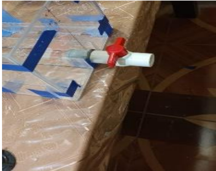
Figura 5. Verificación de la altura de las llaves para el desfogue.
