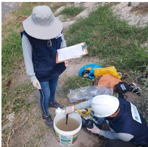
Figura 11. Medición de los parámetros fisicoquímicos mediante el multiparámetro.
