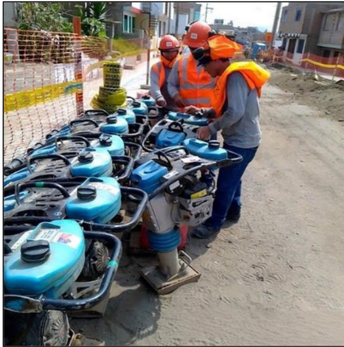
Figura 16. Vibroapisonador en obra
