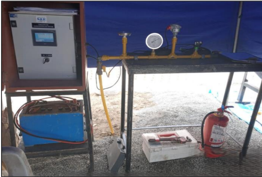
Figura 32. Prueba de Hermeticidad
