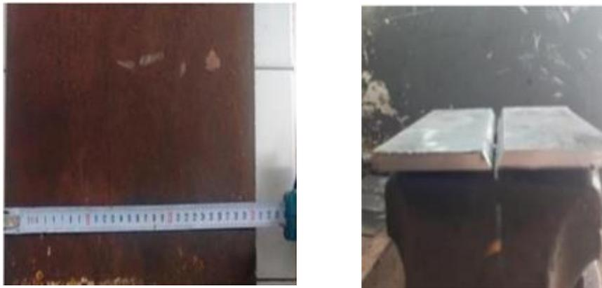
**Figura 7.** Ranura tipo V con un ángulo de 60° y separación de 2mm
